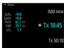
如果在潜水时仅使用一种气体，请确保 **气体** 菜单中仅有这一种气体。否则，Suunto EON Core 会预期将使用列表中的所有气体，并在潜水期间通知您更换气体。
