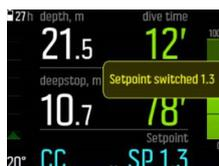
在循环呼吸器潜水过程中，还可以随时切换至自定义设定值。
