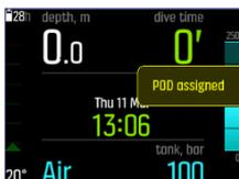
在潜水主视图中，只显示一个罐压，对应于活性气体。更换气体时，显示罐压将相应改变。
