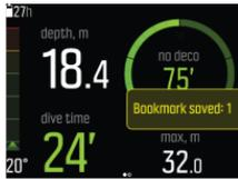
书签会保存以下信息：时间戳、深度、温度和使用 Tank POD 时的压力。数据将在潜水后保存到 Suunto 应用。
