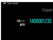
4. 务必确保屏幕上有罐压读数且 POD 绿色 LED 正在闪烁，以此确保 Tank POD 已激活。
