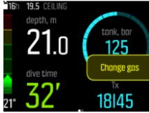
**警告** 使用多种气体潜水时，请记住，上升时间的计算始终基于这样的假设：您将使用**气体**菜单中可以找到的所有气体。潜水之前，应始终检查并确保，仅定义了适用于当前所规划潜水的气体。对于不适用于本次潜水的气体，应将其删除。
