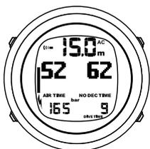
Изменения в потреблении воздуха рассчитываются на основе постоянных измерений давления с интервалом одну секунду, проводимых в течение 30–60 секунд. Рост потребления воздуха быстро сокращает оставшееся время по воздуху, тогда как снижение потребления воздуха приводит к медленному росту этого времени. Поэтому
