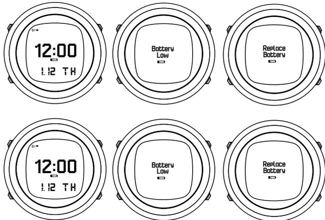
Если значок низкого заряда батареи отображается в поверхностном режиме или дисплей кажется затемненным, вероятно, батарея разряжена. Тогда рекомендуется заменить батарею.
