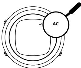
Символ **АС** (AC) отображается вплоть до отключения датчика воды. Важно поддерживать зону датчика воды в чистоте. Загрязнение может помешать автоматическому включению и отключению датчика.
