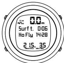
Бесполетный интервал всегда составляет не менее 12 часов и равняется интервалу десатурации, когда его длительность превышает 12 часов. Если интервал десатурации короче 70 минут, бесполетное время не отображается.
