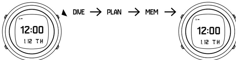
Режимы времени и погружения поддерживают отображение в нижней строке различных представлений, между которыми можно переключаться нажатием кнопок [DOWN] и [UP].
