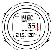
Систематическое превышение скорости подъема приводит к обязательным остановкам безопасности. См. 3.20. Остановки безопасности и остановки на глубине.
