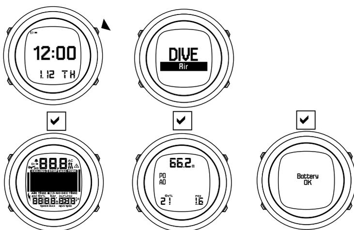
Автоматические проверки между погружениями также выводят на экран текущий уровень насыщения тканей.
