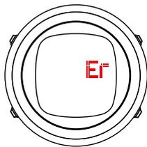
Если пользователь пропускает декомпрессионные остановки дольше 3 (трех) минут, алгоритм RGBM блокируется на 48 часов. Когда алгоритм заблокирован, сведения об алгоритме недоступны. Вместо них отображается сообщение **ER** (Ошибка). Блокировка алгоритма — это функция безопасности, оповещающая о том, что исходные данные алгоритма перестали быть действительными.
