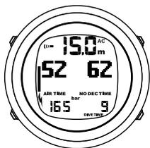
Le changement de consommation d'air est basé sur des mesures de pression constantes prises à intervalle d'une seconde sur des périodes de 30 à 60 secondes. Toute augmentation de la consommation d'air diminue rapidement l'autonomie, tandis qu'une chute de la consommation d'air augmentera progressivement celle-ci. Ainsi, toutes les estimations d'autonomie trop optimistes, causées par une chute temporaire de la consommation d'air, sont ainsi écartées.
