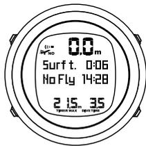
Le temps d'interdiction de vol est d'au moins 12 heures, il est égal au temps de désaturation lorsque ce celui-ci est supérieur à 12 heures. Pour les temps de désaturation inférieurs à 70 minutes, aucun temps d'interdiction de vol ne s'affiche.
