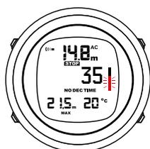
Une vitesse d'ascension excessive répétée entraînera l'apparition de paliers de sécurité obligatoires. Voir 3.20. *Paliers profond et paliers de sécurité.*
