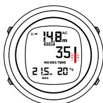
Las infracciones continuas en la tasa de ascenso tienen como resultado paradas de seguridad obligatorias. Ver 3.20. *Paradas de seguridad y paradas profundas.*
