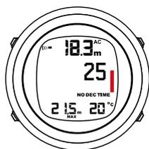
Cuando se supera la tasa máxima de ascenso permitida, el segmento inferior de la barra comienza a parpadear y el segmento superior se mantiene estable.
