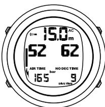
El cambio en el consumo de aire se basa en mediciones constantes de la presión a intervalos de un segundo en periodos de 30–60 segundos. Un aumento en el consumo de aire hace disminuir rápidamente el tiempo de aire restante, mientras que una bajada en el consumo de aire hace aumentar lentamente el tiempo de aire. De esta manera se evita una estimación del tiempo de aire excesivamente optimista debida a una bajada temporal del consumo de aire.
