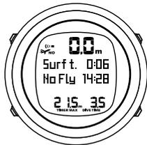
El tiempo de evitación de vuelo es siempre de al menos 12 horas y es igual al tiempo de desaturación cuando es superior a 12 horas. Para tiempos de desaturación inferiores a 70 minutos no se muestra el tiempo de evitación de vuelo.
