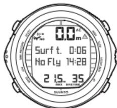
SIE SIND NACH EINEM 35-MINUTEN-TAUCHGANG SEIT 6 MINUTEN WIEDER AN DER OBERFLÄCHE. IHRE MAXIMALE TIEFE LAG BEI 21,5 M, DIE AKTUELLE TIEFE IST 0,0 M. DAS FLUGZEUGSYMBOL UND DIE ANGEZEIGTE FLUGVERBOTSZEIT WEISEN DARAUF HIN, DASS SIE FÜR DIE NÄCHSTEN 14 STUNDEN UND 28 MINUTEN NICHT FLIEGEN SOLLTEN. DAS ACHTUNG-SYMBOL WEIST DARAUF HIN, DASS IHR OBERFLÄCHENINTERVALL NOCH NICHT ABGELAUFEN IST.
