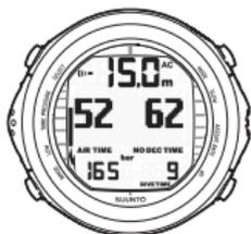
DER AKTUELLE FLASCHENDRUCK LIEGT BEI 165 BAR, DIE RESTLUFTZEIT BETRÄGT 52 MINUTEN.
