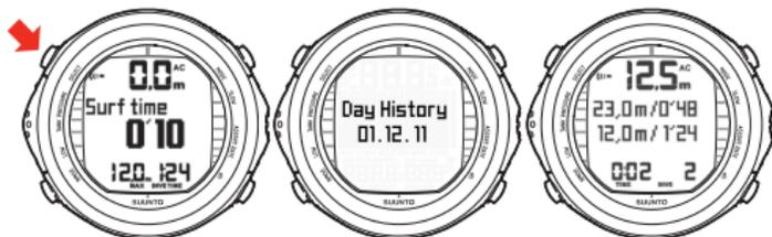
Die Tagesübersicht zeigt die durchschnittliche Tiefe aller Tauchgänge, die größte Tiefe des Tages und den Zeitpunkt ihres Erreichens, den längsten Tauchgang, die Gesamttauchzeit in Stunden und Minuten sowie die Anzahl der während des Tages durchgeführten Tauchgänge.
