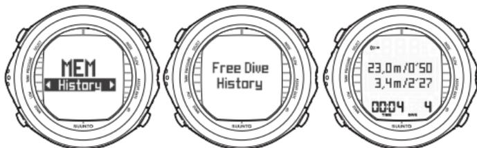
Die Freitauchgang-Übersicht fasst die gesamte Sequenz der Freitauchgänge zusammen. Im Gegensatz zur Tagesübersicht wird die Übersicht der Freitauchgänge nicht automatisch zurückgesetzt.
