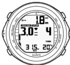
BEI ANZEIGE VON CEILING, STOP UND ABWÄRTSPFEIL SOFORT (INNERHALB VON 3 MINUTEN) MINDESTENS AUF TIEFE DER DEKOSTUFE ABTAUCHEN.
