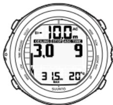
DER NACH OBEN WEISENDE PFEIL IST ERLOSCHEN UND DIE ANZEIGE ASC TIME HAT AUFGEHÖRT ZU BLINKEN. DIES BEDEUTET, DASS SIE DEN DEKOMPRESSIONSBEREICH ERREICHT HABEN.
