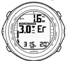
DEKOMPRESSIONSTAUCHGANG, ÜBER DEKOSTUFE. ACHTEN SIE AUF DEN NACH UNTEN WEISENDEN PFEIL, DIE WARNANZEIGE "ER" UND DEN ALARM. SIE SOLLTEN SOFORT (INNERHALB VON 3 MINUTEN) MINDESTENS AUF DIE TIEFE DER DEKOSTUFE ABTAUCHEN.
