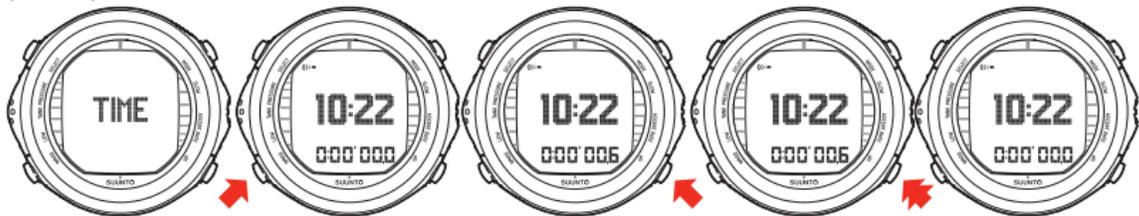
VERWENDEN SIE DIE DOWN-TASTE, UM DIE STOPPUHR ZU STARTEN UND ZWISCHENZEITEN ZU NEHMEN. DIE UP-TASTE STOPPT DIE ZEITNAHME. FALLS SIE ZWISCHENZEITEN GENOMMEN HABEN, KÖNNEN SIE MIT DER UP-TASTE ZWISCHEN DIESEN SCROLLEN. MIT EINEM LANGEN DRUCK SETZEN SIE DIE STOPPUHR AUF NULL ZURÜCK.
