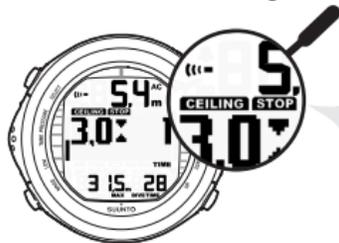
BEI ANZEIGE VON CEILING UND STOP VERBINDLICHEN SICHERHEITSSTOPP IN DER DEKOZONE ZWISCHEN 6 M UND 3 M EINLEGEN.
