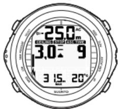
NACH OBEN WEISENDER PFEIL, BLINKENDE ANZEIGE ASC TIME UND ALARMTON WEISEN SIE AUF DEN AUFSTIEG HIN. MINIMALE AUFSTIEGSZEIT EINSCHLIESSLICH SICHERHEITSTOPP IST 9 MINUTEN. DIE DEKOSTUFE LIEGT AUF 3 M.
