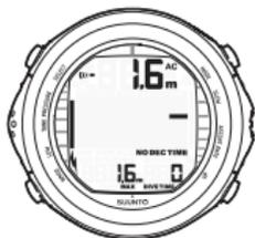
DER TAUCHGANG WURDE GERADE BEGONNEN UND DIE NULLZEIT LIEGT ÜBER 99 MINUTEN, ES WIRD KEIN WERT ANGEZEIGT.
