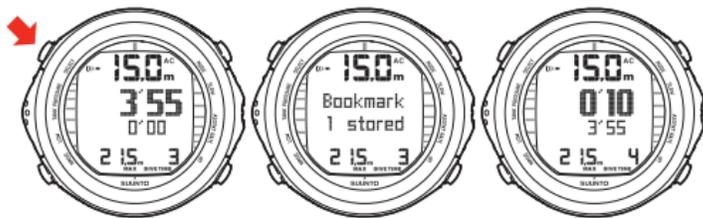
DRÜCKEN DER TASTE SELECT WÄHREND EINES TAUCHGANGS ERSTELLT EIN LESEZEICHEN IM PROFILSPEICHER. DIE ANZEIGE DER TAUCHZEIT WIRD ZURÜCKGESETZT UND DAS BISHERIGE INTERVALL WIRD UNTEN ANGEZEIGT.
