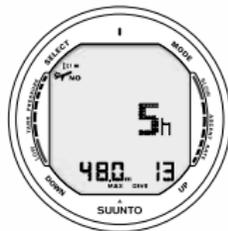
Fig. 7.8 Informazioni della Memoria storica. Numero totale di immersioni effettuate, ore d'immersione e massima profondità mai raggiunta
