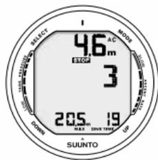
Fig. 6.7 Sosta di Sicurezza Raccomandata, inizia il conto alla rovescia dei 3 minuti di sosta previsti
