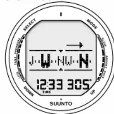
Fig. 4.1. Display bussola (accesso dall'orologio). La direzione attuale è Nord Ovest, 305 gradi. La direzione memorizzata è visibile sul lato sinistro
