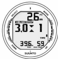
Fig. 6.8 Sosta di Sicurezza Obbligatoria. Indica al subacqueo di effettuare una sosta di sicurezza obbligatoria di 1 minuto fra i 6 ed i 3 metri [20 e 10 ft].
