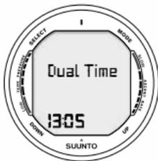
Fig. 3.9. Regolazione del secondo fuso orario
