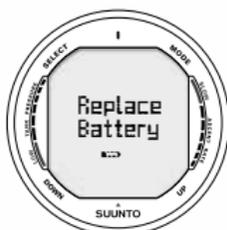
c) batteria da sostituire al più presto
