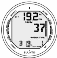
Fig. 6.6. Indicatore di Velocità di Risalita
