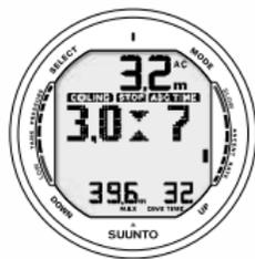
Fig. 6.12. Immersione con decompressione a profondità del Ceiling. Icona a clessidra, le due frecce con le punte rivolte l'una verso l'altra. Si è a profondità di 3,2 m, nella zona ottimale di Ceiling, il tempo totale di risalita minimo è 7 minuti.
