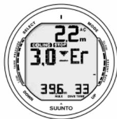
Fig. 6.13. Immersione con decompressione, al di sopra del Ceiling. Notare la freccia rivolta verso il basso, l'allarme Er ed un segnale acustico. Entro al massimo 3 minuti si deve ridiscendere alla profondità del Ceiling o più profondi.
