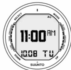
Fig. 2.3. L'attivazione dei contatti bagnati viene visualizzata dal testo AC
