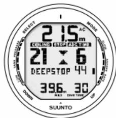
Fig. 6.9 Deep Stop. Indicazione di sosta a 21 metri, il timer indica che mancano 44 secondi alla fine della sosta.
