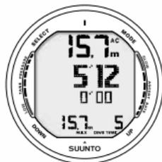
Fig. 6.21. Immersione in programma GAUGE. Il tempo d'immersione è 5 minuti e 12 secondi.
