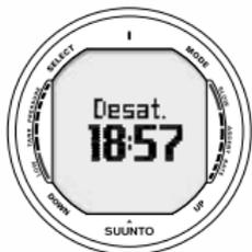
Fig. 7.2. Accesso alla Pianificazione. Il tempo di desaturazione è visibile sul display.
