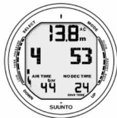
Fig. 6.5 Allarme di pressione bombole. La pressione è scesa al di sotto di 50 bar [725 psi]. Il valore della pressione lampeggia e si attiva un allarme acustico.
