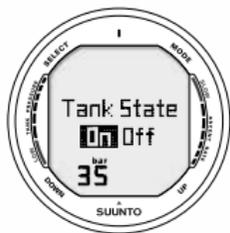
Fig. 5.24. Trasmissione dati via sonda disabilitata (OFF). Premere UP/DOWN per attivare. L'allarme di pressione è impostato su 35 bar.
