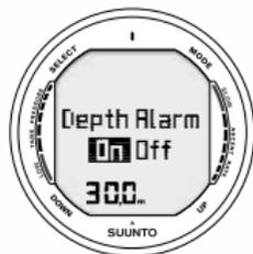
Fig. 5.9 Impostazione dell'allarme di massima profondità. Usare i pulsanti Su e Giù per scegliere ON od OFF e per modificare la profondità.
