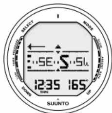
Fig. 4.3. Il triangolo indica che la rotta attuale è per 120 gradi a destra della direzione memorizzata
