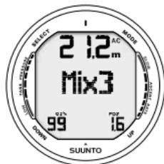
Fig. 6.20. Cambio miscela. Il valore di PO2 reale è superiore a quello impostato, inizia a lampeggiare l'indicazione della PO2. In questo caso la miscela è evidenziata ma non può essere scelta.
