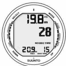
Fig. 6.2. Display in immersione. La profondità attuale è m. 19,8 [66 ft], il tempo di non decompressione, è 28 minuti. La massima profondità raggiunta è stata m. 20,9 [70 ft], il tempo trascorso in immersione è 15 minuti.
