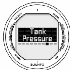
Fig. 5.23. Impostazione del valore della pressione bombola.
