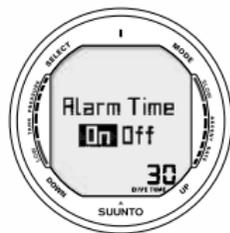
Fig. 5.11. Impostazione dell'Alarme di tempo d'immersione. Premere i pulsanti Su / Giù per scegliere ON od OFF ed impostare il periodo voluto. Premere Select per confermare e passare all'impostazione seguente.
