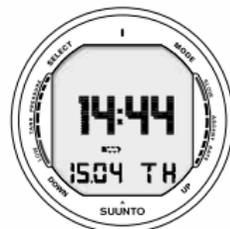
Fig. 5.6. Allarme batteria scarica. L'icona batteria indica che la capacità della batteria è scarsa e che la sostituzione della batteria è raccomandata.
