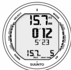
Fig. 6.22. Il Cronometro subacqueo è stato reimpostato. L'ultimo tempo parziale è stato di 5 min e 23 sec. Sono passati 12 secondi del nuovo tempo parziale.
