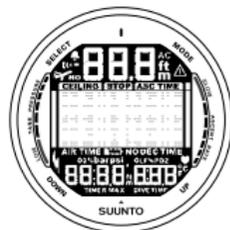
Fig. 5.2. Accensione. Tutti i segmenti vengono visualizzati
