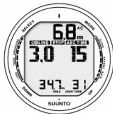
Fig. 6.11. immersione con decompressione, al di sopra di Floor. La freccia rivolta verso l'alto è scomparsa e la scritta ASC TIME ha smesso di lampeggiare, ciò indica che si è in Range di decompressione.
