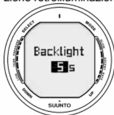
Fig. 3.15. Impostazione della durata retroilluminazione. Premere Su/Giù per scegliere On/Off e per scegliere
