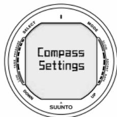
Fig. 4.4. Impostazione della bussola. Forti campi magnetici come linee di tensione, altoparlanti e magneti possono alterare la calibrazione dello strumento. Nel caso di esposizione a tali fonti, è consigliabile procedere alla calibrazione dello strumento.
