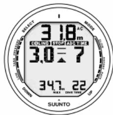
Fig. 6.10. Immersione con decompressione senza deep stop, più profondi del Floor. La freccia con la punta rivolta verso l'alto, la scritta ASC TIME lampeggiante ed un segnale acustico indicano che è opportuno risalire. Il tempo totale di risalita minimo, inclusa la sosta di sicurezza, è 7 minuti. Il Ceiling è a 3 m [10 ft].
