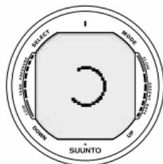
b) La grafica indica l'avanzamento del processo di calibrazione
