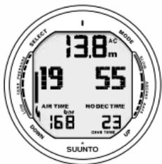
Fig. 6.4. Display in immersione. L'attuale pressione bombola è 168 bar ed il RAT è 19 minuti.
