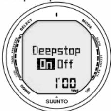
Fig. 5.20 Scelta Deep Stop/ Sosta di Sicurezza. Premere UP/DOWN per modificare l'impostazione
