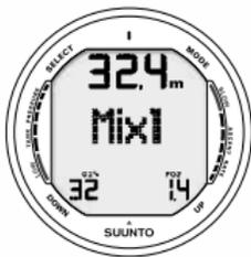
Fig. 5.13. Settaggio di MIX1. La percentuale d'Ossigeno è 32%, la pressione parziale d'ossigeno è 1.4 bar. La corrispondente massima profondità ammissibile è evidenziata sul display ed è 32.4 m [106 ft]. Utilizzare i pulsanti per modificare la percentuale e/ o la pressione parziale d'ossigeno. Confermare i valori impostati premendo il pulsante Select.
