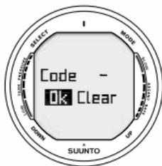
Fig. 5.28. Nessun codice HP selezionato, unità pronta a ricevere il nuovo codice
