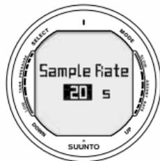
Fig. 5.18. Settaggio dell'Acquisizione Dati. Premere i pulsanti UP/DOWN per cambiare l'intervallo.
