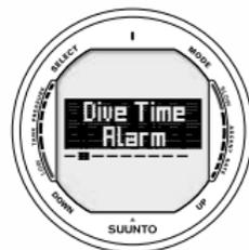
Fig. 5.10 Accesso all'impostazione dell'allarme di tempo
