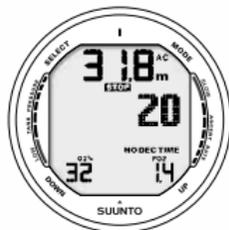
Fig. 6.17. Display PO2. La pressione parziale dell'ossigeno è 1,4 bar
