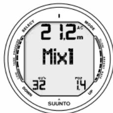
Fig. 6.19 Cambio di miscela. La miscela attuale è MIX1 (32%). Scorrere fra le miscele attivate utilizzando i pulsanti UP e DOWN. Confermare la miscela prescelta premendo il pulsante SELECT.
