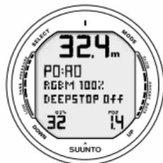
Fig. 6.15. Display Nitrox. La massima profondità ammissibile, basata sulla %  $O_2$  (32%) e su  $PO_2$  (1,4 bar), è m. 32.4.
