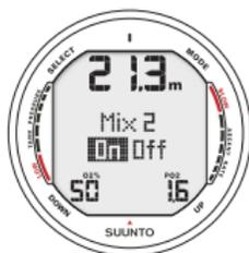
a) MIX 2 ist aktiviert. Der O<sub>2</sub>-Prozentsatz beträgt 50%, der PO<sub>2</sub> beträgt 1,6 bar. Die maximale Tauchtiefe beträgt 21,3 m. Blättern Sie, um den O<sub>2</sub>-Prozentsatz zu verändern und um den PO<sub>2</sub>-Wert zu verändern. Akzeptieren Sie die Einstellungen durch Drücken von SELECT.
