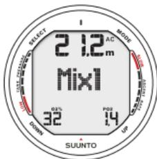
Abb.6.19. Wechsel des Gasgemisches. Das aktuelle Gasgemisch ist MIX 1 (32%). Blättern Sie durch die aktivierten Gasgemische durch Drücken der UP und DOWN-Kontakte. Wählen Sie das neue Gemisch durch Drücken des SELECT-Kontaktes.
