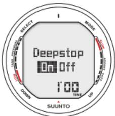
Abb. 5.20. Einstellen der Sicherheitsstopps/ Deep Stops. Drücken Sie UP/ DOWN, um die Einstellungen zu verändern.
