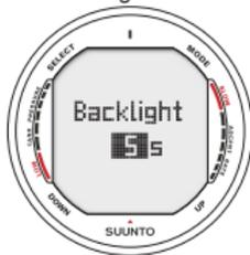
Abb. 3.15. Einstellung der Dauer der Hintergrundbeleuchtung. Drücken Sie UP/ DOWN, um die Werte zu verändern.
