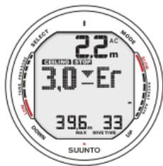
Abb. 6.13. Dekompressionstauchgang oberhalb der Dekompressionsstufe. Beachten Sie den abwärts gerichteten Pfeil und die „Er“-Warnung. Ausserdem hören Sie einen akustischen Alarm. Sie sollten sofort (innerhalb von 3 Minuten) mindestens auf die vorgeschriebene Deko-Stufe oder tiefer abtauchen.
