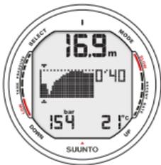
Abb. 7.6. Logbuch, Seite III. Tauchgangsprofil. Drücken Sie UP zum Blättern.
