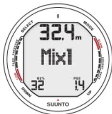
Abb. 5.13. Einstellen des Haupt-Gemisches (MIX 1). Der Sauerstoff-Anteil beträgt 32%, der PO2-Wert die entsprechend maximale Tiefe beträgt 32,4 m [106 ft]. Blättern Sie, um den O2-Prozentsatz zu verändern und um den PO2-Wert zu verändern. Akzeptieren Sie die Einstellungen durch Drücken von SELECT.
