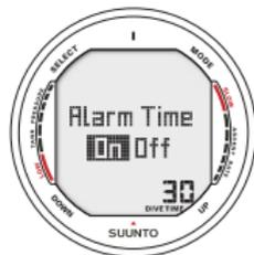
Abb. 5.11. Einstellen des Tauchzeitalarms. Drücken Sie UP/ DOWN, um den Alarm zu aktivieren/ deaktivieren und um die Tauchzeit einzustellen. Drücken Sie SELECT, um die Einstellung zu bestätigen/ die nächste Einstellung zu wählen.
