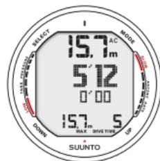
Abb. 6.21. Tauchen im Tiefenmesser-Modus. Die aktuelle Tauchzeit beträgt 5 Minuten und 12 Sekunden.
