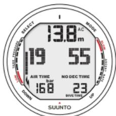
Abb. 6.4. Display während des Tauchgangs. Der aktuelle Flaschendruck beträgt 168 bar, die Restluftzeit beträgt 19 Minuten.
