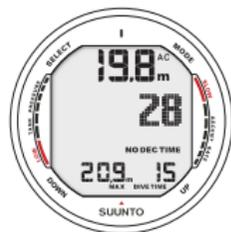
Abb. 6.2. Anzeige während des Tauchgangs. Die aktuelle Tiefe ist 19,8m [66 ft] und die Nullzeit beträgt 28 Minuten. Die maximal bei diesem Tauchgang erreichte Tiefe war 20,9 m [70 ft], bisherige Tauchzeit ist 15 Minuten.
