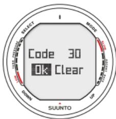
Abb. 5.29. Das Gerät ist auf Kanal 30 gepaart. Wählen Sie clear zum Löschen des Codes, OK zum Bestätigen.
