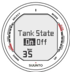
Abb. 5.24. Schlauchlose Druckübertragung deaktiviert (OFF), drücken Sie UP/ DOWN zur Aktivierung. Der Flaschendruck-Alarm ist derzeit auf 35 bar gestellt.
