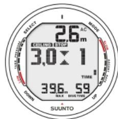
Abb. 6.8. Verbindlicher Sicherheitsstopp. Es wird Ihnen empfohlen, einen verbindlichen Sicherheitsstopp zwischen 6m und 3 m [20 ft und 10 ft] zu machen .
