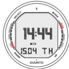
Abb. 5.6. Batteriewarnung. Das Batteriesymbol weist darauf hin, dass die Batteriespannung gering ist und ein Batteriewechsel dringend empfohlen ist.
