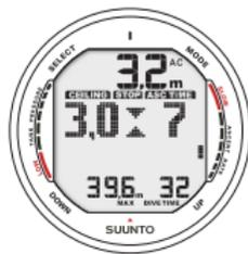
Abb. 6.12. Dekompressionstauchgang innerhalb der Dekompressionszone. Zwei gegenüber gerichtete Pfeile (Sanduhr) erscheinen. Sie befinden sich im optimalen Deko-Bereich in 3.2m [11 Fuss] Tiefe und Ihre minimale Aufstiegszeit beträgt 7 Minuten.
