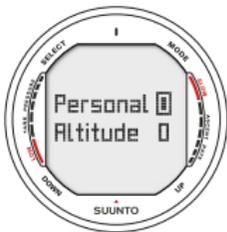
Abb. 5.16. Einstellungen der persönlichen und Höhenanpassung. Blättern Sie mit Hilfe der Druckkontakte, um die persönliche Anpassung zu ändern. Bestätigen Sie mit SELECT.
