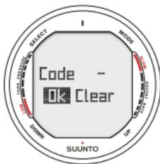
Abb. 5.28. Kein Code gespeichert. Das Gerät ist bereit, mit dem Sender gepaart zu werden.
