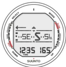
Abb. 4.3. Dreieck weist darauf hin, dass Sie sich 120° rechts von der fixierten Kurspeilung befinden.
