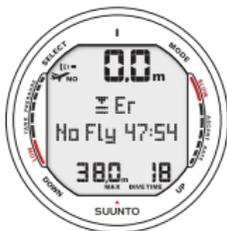
Abb. 6.25. Oberflächenmodus nach Nichtbeachten einer Dekompressionsstufe. Das "Er"-Symbol wird gezeigt, weil Sie eine Dekompressionsstufe länger als 3 Minuten nicht beachtet haben. Sie dürfen innerhalb der nächsten 48 Stunden nicht tauchen.
