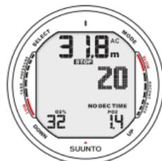
Abb. 6.17. PO<sub>2</sub>-Anzeige. Der Sauerstoffpartialdruck beträgt 1,4 bar.
