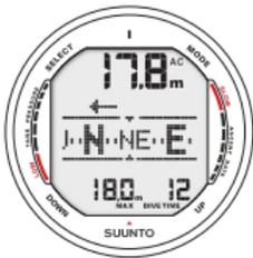
Abb. 6.23. Die Aktivierung des Kompasses aus dem Tauchmodus.
