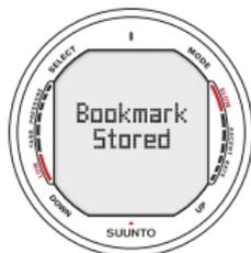
Abb. 6.3. Hinterlegen eines Lesezeichens. Ein Lesezeichen wird im Profilspeicher während des Tauchgangs eingetragen, indem der SELECT-Kontakt gedrückt wird. Beachten Sie das Logbuchsymbol, links neben der Tiefe.
