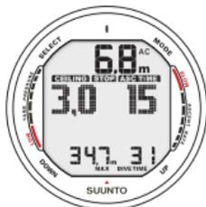
Abb. 6.11. Dekompressionstauchgang oberhalb der Dekompressionsgrenze. Der aufwärts gerichtete Pfeil ist verschwunden und ASC TIME blinkt nicht mehr, d.h. Sie befinden sich im Dekompressionsbereich.
