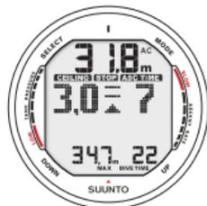
Abb. 6.10. Dekompressionstauchgang unterhalb der Dekompressionsgrenze, ohne Deep Stops. Der aufwärts gerichtete Pfeil, ein akustischer Alarm und die blinkende Anzeige ASC TIME weisen darauf hin, aufzusteigen. Die minimale Aufstiegszeit beinhaltet den Sicherheitsstopp und beträgt 7 Minuten. Die Deko-Stufe liegt bei 3m [10 Fuss].
