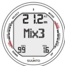
Abb. 6.20. Wechsel des Gasgemisches. Die maximale Einsatztiefe (MOD) ist überschritten, das Gas kann nicht gewählt werden. Der  $PO_2$ -Wert beginnt zu blinken.
