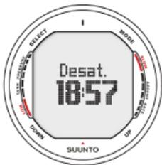
Abb. 7.2. Sie gelangen in den Tauchgangsplanungs-Modus. Restsättigungszeit wird angezeigt.
