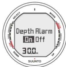
Abb. 5.9. Einstellen des Maximaltiefenalarms. Drücken Sie UP/ DOWN, um den Alarm zu aktivieren/ deaktivieren und um die Tiefe einzustellen.
