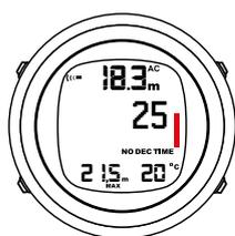
Quando a velocidade de subida máxima é ultrapassada, o segmento inferior da barra fica intermitente e o segmento superior fica imóvel.
