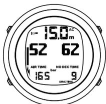
A alteração no seu consumo de ar é baseada nas medições de pressão em intervalos constantes de um segundo por períodos de 30-60 segundos. Um aumento do consumo de ar reduz rapidamente o tempo de ar restante, ao passo que uma diminuição do consumo de ar aumenta lentamente o tempo de ar restante. Deste modo, pode evitar-se uma estimativa de tempo de ar excessivamente otimista, causada por uma queda temporária do consumo de ar.
