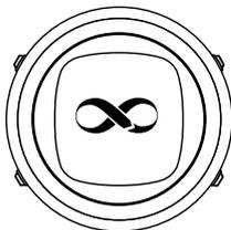
Calibre a bússola, rodando lentamente a unidade na sua mão em grandes ciclos na forma de um 8.
