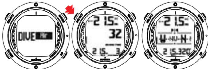
BEI ZUGRIFF AUS DEM DIVE-MODUS WERDEN AKTUELLE TIEFE ODER MAXIMALE TIEFE SOWIE RICHTUNG, TAUCHZEIT ODER TEMPERATUR ANGEZEIGT.
