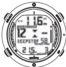
ES WIRD EMPFOHLEN, AUF EINER TIEFE VON 12 M EINEN DEEP STOP EINZULEGEN. DIE ZWEITE ANZEIGE ZEIGT, DASS DER DEEP STOP NOCH 58 SEKUNDEN DAUERT.
