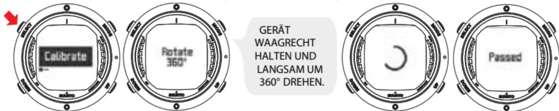
Falls die Kalibrierung mehrmals hintereinander fehlschlägt, befinden Sie sich möglicherweise in der Nähe einer Magnetquelle (z. B. größere Metallgegenstände, elektrische Leitungen oder Elektrogeräte). Ändern Sie Ihre Position und versuchen Sie erneut, den Kompass zu kalibrieren. Falls die Kalibrierung auch nach wiederholten Versuchen nicht gelingt, wenden Sie sich bitte an ein autorisiertes Suunto-Kundendienstcenter.
