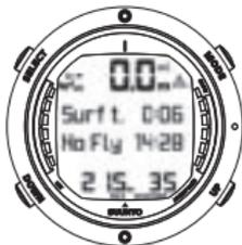
SIE SIND NACH EINEM 35-MINUTEN-TAUCHGANG SEIT 6 MINUTEN WIEDER AN DER OBERFLÄCHE. IHRE MAXIMALE TIEFE LAG BEI 21,5 M, DIE AKTUELLE TIEFE IST 0,0 M. DAS FLUGZEUGSYMBOL UND DIE ANGEZEIGTE FLUGVERBOTSZEIT WEISEN DARAUF HIN, DASS SIE FÜR DIE NÄCHSTEN 14 STUNDEN UND 28 MINUTEN NICHT FLIEGEN SOLLTEN. DAS ACHTUNG-SYMBOL WEIST DARAUF HIN, DASS IHR OBERFLÄCHENINTERVALL NOCH NICHT ABGELAUFEN IST.
