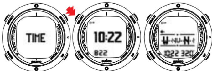
BEI ZUGRIFF AUS DEM TIME-MODUS WERDEN UHRZEIT UND RICHTUNG UNTEN IN DER ANZEIGE DARGESTELLT.
