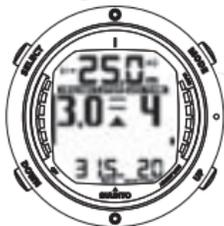
NACH OBEN WEISENDER PFEIL, BLINKENDE ANZEIGE ASC TIME UND ALARMTON WEISEN SIE AUF DEN AUFSTIEG HIN. MINIMALE AUFSTIEGSZEIT EINSCHLIESSLICH SICHERHEITSTOPP IST 4 MINUTEN. DIE DEKOSTUFE LIEGT AUF 3 M.
