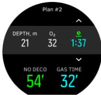
Waktu tanpa dekompresi dihitung berdasarkan kedalaman penyelaman dan campuran gas. Setiap sisa nitrogen dari penyelaman sebelumnya, serta waktu permukaan, dipertimbangkan. **Gas time** bergantung pada kedalaman penyelaman, campuran gas, konsumsi pribadi, dan ukuran/tekanan tangki.
