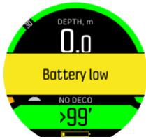
Ketika waktu yang tersisa berkurang menjadi dua jam, notifikasi berwarna merah 'Recharge needed' (Perlu dicas) muncul jika Anda berada di permukaan. Pesan berwarna merah tersebut akan tetap ada paling depan di layar dan tidak dapat dihilangkan hingga Anda mengecras perangkat atau mengubah ke tampilan waktu. Dalam hal selam skuba, ketika tingkat daya turun di bawah dua jam, Anda tidak dapat memulai penyelaman dengan Suunto D5. Untuk selam bebas, batasnya adalah 30 menit.
