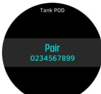
2. Pastikan bahwa Tank POD telah diaktifkan dengan memastikan bahwa bacaan tekanan tangki tampil di layar dan berada dalam kisaran yang aman. Pada menu, Tank POD diidentifikasi dengan nomor seri yang tercetak pada Tank POD.
