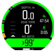
Waktu larangan terbang adalah waktu permukaan minimum setelah penyelaman yang disarankan untuk dilewatkan sebelum naik dan terbang dengan pesawat terbang. Waktu larangan terbang selalu setidaknya 12 jam dan sama dengan waktu desaturasi apabila lebih dari 12 jam. Untuk waktu desaturasi yang kurang dari 75 menit, waktu larangan terbang tidak ditampilkan.
