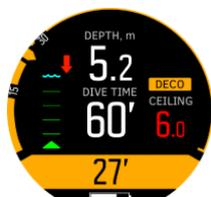
En este caso, deberás descender por debajo del nivel de techo para continuar la descompresión. Si no lo haces en los (3) minutos siguientes, el Suunto D5 bloquea el cálculo del algoritmo y muestra en su lugar el mensaje **Bloq.**, según se muestra a continuación. Como ves, el valor de techo ya no está presente.
