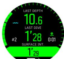
Si **Notificación de superficie** está desactivado, el contador de intervalo en superficie funciona durante 4 horas; después de transcurrido este tiempo o el tiempo de intervalo en
