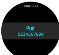
2. Asegúrate de que el Tank POD esté activado comprobando que haya una lectura de presión de la botella en la pantalla, y que esté dentro de los límites. En el menú, el Tank POD se identifica por el número de serie impreso en el Tank POD.
