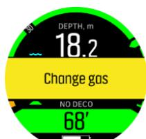
**⚠ ADVERTENCIA:** Al bucear con múltiples gases, recuerda que el tiempo de ascenso se calcula siempre asumiendo que utilizas todos los gases del menú **Gases**. Comprueba siempre antes de la inmersión que tienes definidos solo los gases para tu inmersión planificada actual. Elimina los gases que no estén disponibles para la inmersión.
