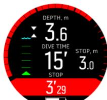
**NOTA:** Si asciende por encima del techo y permanece a esa profundidad durante más de 3 minutos, el algoritmo de descompresión se bloquea.
