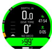
El tiempo de espera para volar es el tiempo mínimo en superficie recomendado después de una inmersión antes de entrar en un avión o volar. Es siempre de al menos 12 horas y es igual al tiempo de desaturación cuando es superior a 12 horas. Para tiempos de desaturación inferiores a 75 minutos no se muestra el tiempo de espera para volar.
