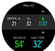
El tiempo sin descompresión calculado se basa en la profundidad de la inmersión y la mezcla de gases. Se tiene en cuenta el nitrógeno residual de inmersiones previas, así como el tiempo en superficie. El **tiem. gas** depende de la profundidad de la inmersión, la mezcla de gases, el consumo personal y la presión/el tamaño de la botella.
