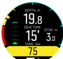
Cuando la presión de la botella baja a menos de 50 bares (dentro del área roja del arco) el valor real de presión de la botella se indica en un campo rojo en la ventana de cambio y se dispara una alarma obligatoria:
