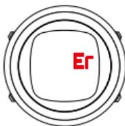
Если пользователь пропускает декомпрессионные остановки дольше 3 (трех) минут, алгоритм RGBM блокируется на 48 часов. Когда алгоритм заблокирован, сведения об алгоритме недоступны. Вместо них отображается сообщение **Er** (Ошибка). Блокировка алгоритма
