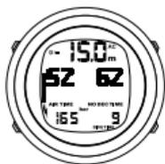
Изменения в потреблении воздуха рассчитываются на основе постоянных измерений давления с интервалом одну секунду, проводимых в течение 30–60 секунд. Рост потребления воздуха быстро сокращает оставшееся время по воздуху, тогда как снижение потребления воздуха приводит к медленному росту этого времени. Поэтому оценка времени по воздуху никогда не бывает чрезмерно оптимистичной, даже в случае временного снижения потребления воздуха.
