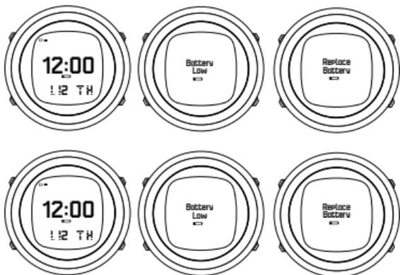
Se in modalità superficie compare l'icona di batteria scarica o se il display è sbiadito, la batteria potrebbe essere scarica. Si consiglia di sostituire la batteria.
