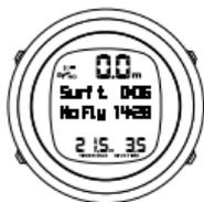
Il tempo di non volo è sempre di almeno 12 ore o comunque equivalente al tempo di desaturazione (se questo è superiore alle 12 ore). Per tempi di desaturazione inferiori a 70 minuti non viene visualizzato alcun tempo di non volo.
