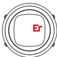
Se non si eseguono le soste di decompressione indicate per più di tre (3) minuti, l'algoritmo RGBM entra in blocco per 48 ore. Quando l'algoritmo è bloccato, non è disponibile alcuna informazione e sul display appare invece la scritta **Er** (Errore). Il blocco dell'algoritmo è una misura di sicurezza atta a segnalare che i dati relativi all'immersione non sono più validi.
