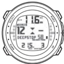
È NECESSARIO EFFETTUARE UNA SOSTA DI PROFONDITÀ A 12 M. L'INDICATORE DEI SECONDI MOSTRA CHE MANCANO 58 SECONDI AL COMPLETAMENTO DI TALE SOSTA.
