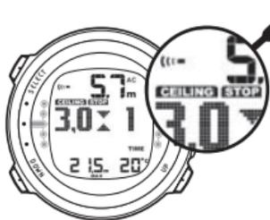
QUANDO COMPAIONO LE SCRITTE STOP E CEILING, EFFETTUARE UNA SOSTA DI SICUREZZA OBBLIGATORIA DI UN MINUTO NEL CAMPO DI PROFONDITÀ COMPRESO TRA 6 METRI E 3 METRI.
