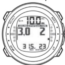
LA SCOMPARSA DELLA FRECCIA VERSO L'ALTO E L'ARRESTO DEL LAMPEGGIO DEL TEMPO DI RISALITA INDICANO CHE SI È NEL CAMPO DI DECOMPRESSIONE.
