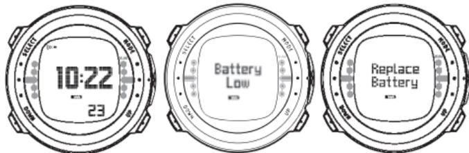
Se in modalità Surface appare il simbolo batteria o se il display è sbiadito o debole, la batteria potrebbe essere troppo scarica per alimentare correttamente il computer. Se ne raccomanda la sostituzione immediata.
