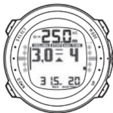
LA FRECCIA VERSO L'ALTO, IL TEMPO DI RISALITA CHE LAMPEGGIA E UN ALLARME INDICANO CHE È NECESSARIO RISALIRE. IL TEMPO DI RISALITA COMPLESSIVO MINIMO, COMPRESA LA SOSTA DI SICUREZZA È DI 4 MINUTI. IL TETTO È A 3 M.
