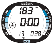
Fig. 3.8. Plaatsing van een Bookmark. U kunt een aandachtspunt of Bookmark in het profielgeheugen plaatsen door op de S knop te drukken (succesvol plaatsen wordt aangegeven met het oplichten van het Attentiesymbool).
