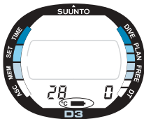
Fig. 3.7. Waarschuwing voor lage batterijspanning. Het batterijsymbool geeft aan dat de batterijspanning te laag is en deze vervangen moet worden.
