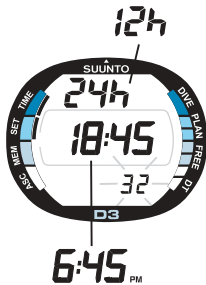
Fig. 4.3. De Tijdsinstellingenmodus is geactiveerd en de seconden knipperen. Pagina I.
