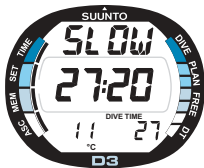
Fig. 3.20. Stijgsnelheidsmeter. De SLOW waarschuwing knippert en alle vier segmenten lichtten op. Gelijktijdig klinkt een akoestische waarschuwing. De stijgsnelheid is groter dan 10m/min [33ft/min].
