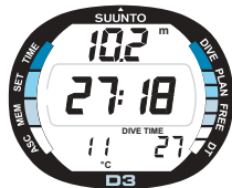
Fig. 3.18. Het duikdisplay. De huidige diepte is 10.2m. De timer laat een duiktijd zien van 27 minuten en 18 seconden. De watertemperatuur en de duiktijd staan onderaan het display.
