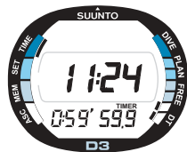
Fig. 2.9. De Timer telt terug vanaf een vooraf ingestelde tijd. De functie-indicator knippert.
