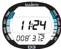
Fig. 2.7. De Stopwatch toont de gemeten tijd in uren, minuten en seconden.
