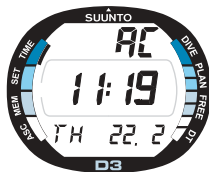
Fig. 2.3. Activering van het watercontact wordt aangeduid met de tekst AC.
