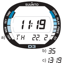
Fig. 2.5. Het tijdsdisplay a) de datum wordt weergegeven b) de seconden worden weergegeven c) de tijd in de tweede tijdszone wordt weergegeven
