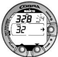
图 5.4. 设置氧气百分比和分压。等量最大深度显示为 32.8 米/107 英尺。按滚动按钮来更改氧气百分比和设置氧气分压设置值。
