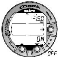
图 5.3. 设置最大深度警报。按滚动按钮来更改警报的开/关状态以及设置最大深度值。
