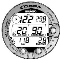
图 6.4. 书签启用。在潜水过程中按“PLAN”（计划）按钮，书签注释将位于资料内存中。注意潜水日志符号。
