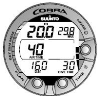
图 6.17. 仪表模式。在潜水中将显示当前深度、最大深度、潜水时间、气瓶压力、剩余空气时间和上升速率指示器。
