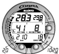
图 6.3. 潜水显示屏。当前气瓶压力为 210 bar/3045 psi，剩余空气时间为 41 分钟。在按下 TIME（时间）按钮后，当前时间和温度的其他屏幕将显示 5 秒钟。
