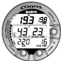
图 6.2. 潜水显示屏。当前深度为 19.3 米/63 英尺，免减压停留时间限制在 A0/P1 模式中为 23 分钟。本次潜水中的最大深度为 19.8 米/65 英尺，已消耗潜水时间为 16 分钟。
