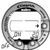
图 5.2. 设置潜水时间警报。按滚动按钮来更改警报的开/关状态以及设置潜水时间值。
