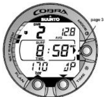
图 7.7. 第 III 页的潜水日志。水面间隔时间、平均深度和以 \Delta P 指示的空气消耗。
