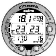
图 6.16. 最低条形图闪烁以表明 OLF 值与 OTU 相关。
