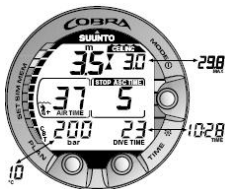
图 6.11. 处于最小减压深度区域的减压潜水。两个对指箭头（“沙漏”）。您处于 3.5 米/11 英尺的最佳最小减压深度区域，您的最小上升时间为 5 分钟。按 TIME（时间）按钮启用其他显示。
