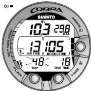
图 6.5. 气瓶压力警报。压力已降到 50 bar /725 psi 以下。压力显示屏闪烁，并发出声音警报。
