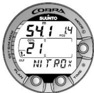
图 6.13. 高氧显示。基于设置 02% (21%) 和 PO 2 (1.4 bar) 的最大深度为 54.1 米/177 英尺。
