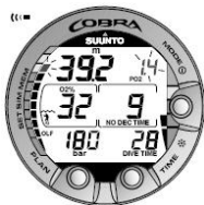
图 6.14. 氧气分压和 OLF 显示。如果氧气分压大于 1.4 bar 或设置值，以及/或者 OLF 到达 80% 的限值，声音警报将响起。
