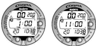
图 7.2. 水面间隔、水面时间和禁飞时间显示：按下 TIME（时间）按钮一次，将出现水面时间显示屏，按下 TIME（时间）按钮两次，将显示以飞机符号指示的禁飞时间显示屏。
