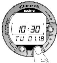
图 3.1. 计时显示屏。按 PLAN（计划）或 TIME（时间）按钮可启用显示屏。
