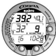
图 6.15. 其他显示屏。如果空气时间小于 30 分钟，按下 TIME（时间）按钮将显示当前时间、最大深度、温度、CBT 和 02%。
