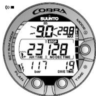
图 6.6. 上升速率指示器。深度读数闪烁，SLOW（减速）和四个区段显示：上升速率高于 10 米/分钟/33 英尺/分钟。注意要减速！STOP（停止）符号表示当您到达 6 米/20 英尺深度时建议进行强制安全保留。
