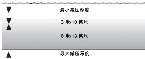
图 6.8. 最小减压深度和最大减压深度。6 米和 3 米/20 英尺和 10 英尺之间的建议和强制安全停留区域。
