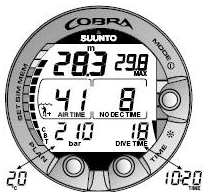
Figur 6.3. Dykdisplayen. Aktuellt flasktryck är 210 bar/3 045 psi och återstående lufttid är 41 minuter. Den alternativa displayen för aktuellt klockslag och temperatur visas i fem sekunder om du trycker på TIME.
