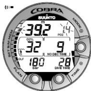
Figur 6.14. Visning av syrets partialtryck och OLF. Datorn ger ifrån sig en ljudsignal om syrets partialtryck stiger över 1,4 bar eller till inställt värde och/eller OLF når 80-procentsgränsen.
