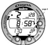
Figur 7.7. Logg, sida III. Ytintervalltid, genomsnittsdjup och förbrukad luft indikerat av \Delta P .
