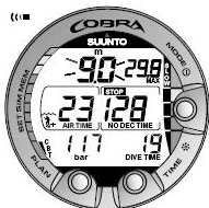
Figur 5.8. Indikator för uppstigningshastighet. Två segment.
