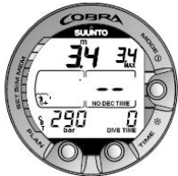
Figur 6.1. Dyket har just påbörjats och inget värde för lufttid visas. Den första uppskattningen av hur mycket luft som återstår i tid visas efter 30–60 sekunder.
