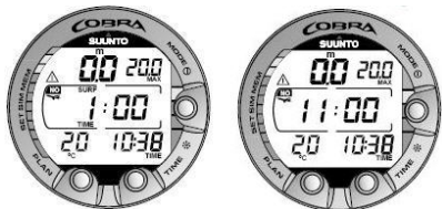
Figur 7.2. Visning av ytintervall, yttid och flygvarningstid: Om du trycker en gång på TIME-knappen visas yttiden. Om du trycker två gånger på TIME-knappen visas flygvarningstiden med flygplanssymbolen.
