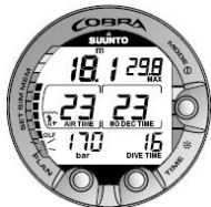
Figur 6.16. Det lägsta segmentet blinkar för att indikera att OLF-värdet som visas avser OTU.
