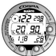
Figur 6.4. Bokmärkesaktivering. Tryck på PLAN-knappen för att lägga till en anteckning – ett bokmärke – i profilminnet under ett dyk. Notera loggsymbolen.
