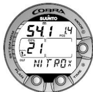
Figur 6.13. Nitrox-display. Maxdjup baserat på inställda värden för O_2 % (21 %) och PO_2 (1,4 bar) är 54,1 m/177 fot.
