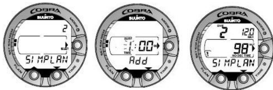
Figur 7.13. Läge för dykplaneringssimulator [2 SIMPLAN]. Lägg till önskade ytintervallökningar (till aktuellt ytintervall) genom att trycka på TIME- och PLAN-knapparna. Denna displaybild visas endast vid upprepade dyk.
