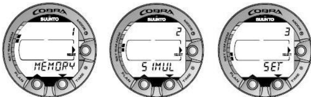
Figur 4.2. Bläddra mellan lägesalternativen genom att trycka på uppåt- och nedåtknapparna.
