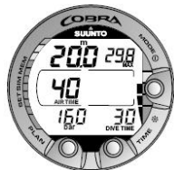
Figur 6.17. GAUGE-läget. Aktuellt djup, maxdjup, dyktid, flasktryck, återstående lufttid och indikator för uppstigningshastighet visas under dyket.
