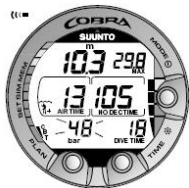
Figur 6.5. Varningar för flasktryck. Trycket har sjunkit under 50 bar/725 psi. Tryckdisplayen blinkar och ett ljudlarm hörs.
