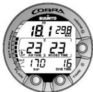
Рисунок 6.16. Мигание нижней полоски дисплея указывает на то, что отображаемое значение OLF относится к OTU.
