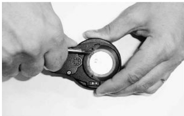
Рисунок 9.1. Открытие стопорного кольца.
