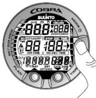
Рисунок 5.5. Пуск I. Все сегменты отображаются.
