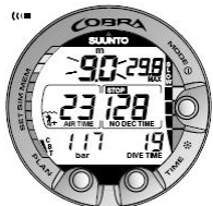
Рисунок 5.8. Индикатор скорости подъема. Два сегмента.
