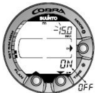
Figuur 5.3. Alarm voor maximale diepte instellen. Druk op de bladerknoppen om een alarm in of uit te schakelen en de maximale diepte in te stellen.
