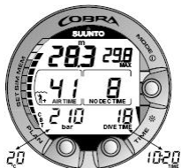
Figuur 6.3. Duikvenster. Huidige flesdruk is 210 bar en resterende luchtijd 41 minuten. Alternatieve venster met huidige tijd en temperatuur wordt gedurende 5 seconden weergegeven na het indrukken van de knop TIME.
