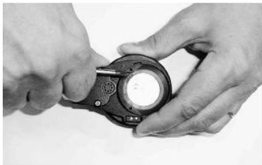
Figuur 9.1. De borgring openen.
