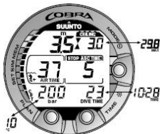
Figuur 6.11. Decompressieduik, in decompressiezone. Twee naar elkaar gerichte pijlen ('zandloper'). U bevindt zich in de optimale decompressiezone op een diepte van 3,5 meter en de minimaal benodigde opstijgtijd is 5 minuten. Met een druk op de knop TIME wordt het alternatieve venster geactiveerd.
