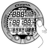
Figuur 5.5. Opstarten I. Alle segmenten zichtbaar.
