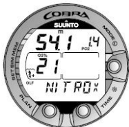
Figuur 6.13. Venster voor Nitrox. Maximale diepte op basis van ingesteld O 2 % (21%) en PO 2 (1,4 bar) is 54,1 meter.
