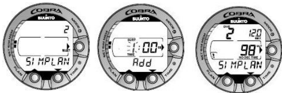
Figuur 7.13. Modus Duikplanningsimulator [2 SIMPLAN] U voegt de gewenste stap voor de oppervlakte-intervallen toe (aan de huidige oppervlakte-interval) door te drukken op de knop TIME en PLAN. Deze display wordt alleen getoond voor herhalingsduiken.
