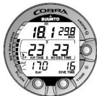
Figure 5.16. La graphique en barres le plus bas clignote pour indiquer que la valeur OLF affichée correspond à la valeur OTU.
