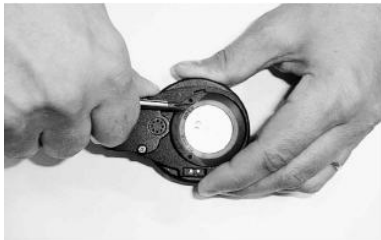
Figure 8.1. Ouverture du joint de sécurité.
