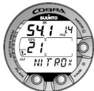
Figure 5.13. Affichage nitrox. Profondeur maximale d'après la valeur O_2\% définie (21 %) et PO_2 (1,4 bar) : 54,1 m (177 ft).
