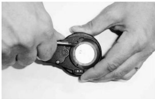
Figura 9.1. Apertura del anillo de sujeción.
