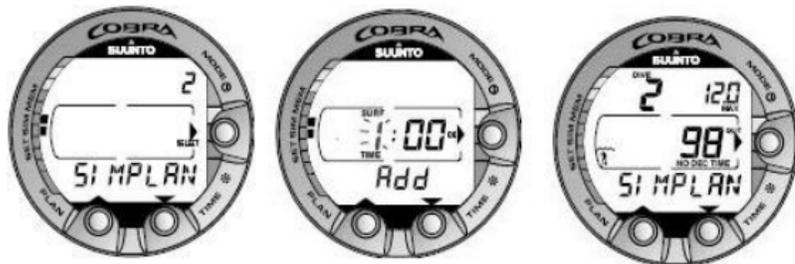
Figura 7.13. Modo de simulador de planificación de inmersión [2 SIMPLAN]. Añada el incremento de intervalo en superficie deseado (para presentar el intervalo en superficie mostrado) presionando los botones TIME y PLAN. Esta pantalla sólo se muestra para las inmersiones repetitivas.
