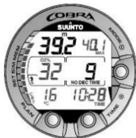
Figura 6.15. Pantalla alternativa. Al pulsar el botón TIME se muestran la hora actual, la profundidad máxima, la temperatura, el tiempo de fondo y el O2%, si el tiempo de aire es inferior a 30 minutos.
