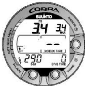
Figura 6.1. La inmersión acaba de comenzar y no se muestra ningún tiempo de aire. La primera estimación del tiempo de aire restante se muestra tras 30–60 segundos.
