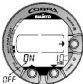
Figura 4.7. Ajuste de tiempo de encendido de luz de fondo. Presione los botones de desplazamiento para activar o desactivar la luz de fondo y para ajustar el valor de tiempo.
