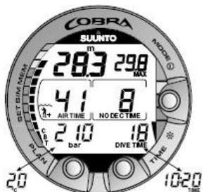
Figura 6.3. Pantalla de inmersión. La presión actual de las botellas es de 210 bares/3.045 psi y el tiempo de aire restante es de 41 minutos. La pantalla alternativa de hora y temperatura actuales se muestra durante 5 segundos tras pulsar el botón TIME.
