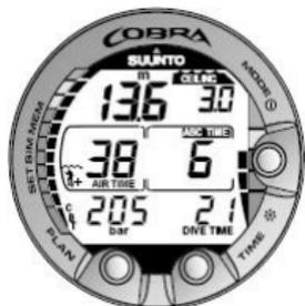
Figura 6.10. Inmersión con descompresión, por encima del suelo. La flecha hacia arriba ha desaparecido y el indicador ASC TIME ha dejado de parpadear, lo que significa que se encuentra en el intervalo de descompresión.
