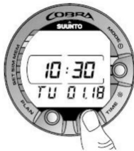
Figura 3.1. Pantalla de tiempos. Presione el botón PLAN o TIME para activar la pantalla.
