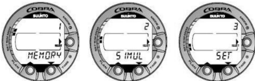
Figura 4.2. Para desplazarse entre las opciones de los modos, presione los botones de flecha hacia arriba y hacia abajo.
