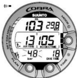
Figura 6.5. Advertencias de presión de la botella. La presión ha bajado por debajo de los 50 bares/725 psi. La indicación de presión parpadea y se emite un tono sonoro.
