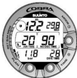
Figura 6.4. Activación de marcador. Para colocar un marcador en la memoria de perfiles durante una inmersión se pulsa el botón PLAN. Observe el símbolo de Diario de buceo.
