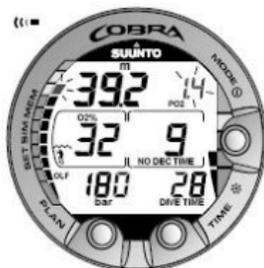
Figura 6.14. Pantallas de presión parcial de oxígeno y FLO. Se produce una alarma sonora si la presión parcial de oxígeno es mayor que 1,4 bares o el valor establecido y/o el FLO ha alcanzado el límite del 80%.
