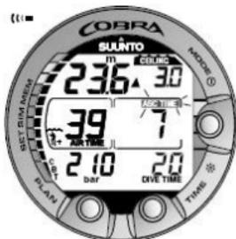
Figura 6.9. Inmersión de descompresión, por debajo del suelo. Flecha hacia arriba parpadeante, indicador ASC TIME y alarma que le indican que debe ascender. El tiempo mínimo total del ascenso, incluida la parada de seguridad, es de 7 minutos. El techo se encuentra en los 3 m/10 pies.
