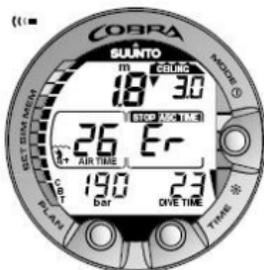
Figura 6.12. Inmersión de descompresión, por encima del techo. Observe la flecha hacia abajo, la advertencia Er y la alarma sonora. Debe descender inmediatamente (en los 3 minutos siguientes) hasta el techo o por debajo de él.
