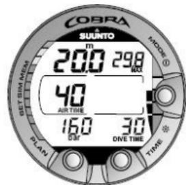
Figura 6.17. Modo Gauge (Profundímetro). Se muestran durante la inmersión la profundidad actual, profundidad máxima, tiempo de inmersión, presión de botellas, tiempo de aire restante e indicador de velocidad de ascenso.
