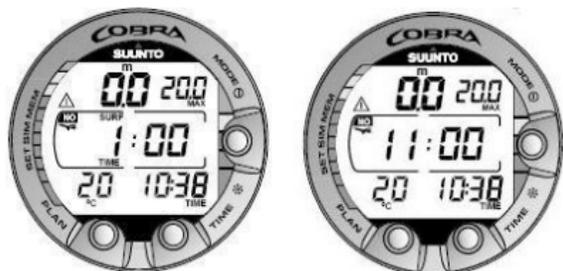
Figura 7.2. Intervalo en superficie, pantallas de tiempo en superficie y tiempo sin vuelo: si se presiona una vez el botón TIME, se muestra la pantalla de tiempo en superficie, y si se presiona dos veces el botón TIME, se muestra la pantalla de tiempo sin vuelo, indicado mediante el símbolo de avión.
