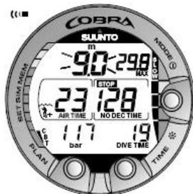
Figura 6.6. Indicador de velocidad de ascenso. Lectura de profundidad parpadeante, SLOW y cuatro segmentos mostrados: La velocidad de ascenso es superior a los 10 m/min/33 pies/min. ¡Esto es una advertencia de que debe reducir la velocidad! El símbolo STOP significa que se le recomienda que haga una parada de seguridad obligatoria a la profundidad de 6 m/20 pies.
