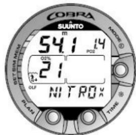
Figura 6.13. Pantalla de nítrox. La profundidad máxima, basada en los ajustes de  $O_2\%$  (21%) y  $PO_2$  (1,4 bares) es de 54,1 m/177 pies.
