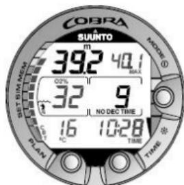
Abbildung 6.15. Alternative Ansicht. Durch Drücken der Taste TIME wird die aktuelle Uhrzeit, maximale Tiefe, Temperatur, CBT und O2% angezeigt, wenn die Restluftzeit weniger als 30 Minuten beträgt.
