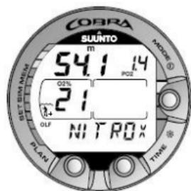
Abbildung 6.13. Nitrox-Ansicht. Die maximale Tauchtiefe basierend auf den eingestellten Werten für  $O_2$  (21 %) und  $PO_2$  (1,4 bar) liegt bei 54,1 m (177 ft).
