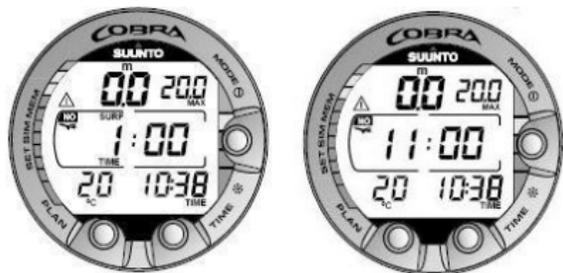
Abbildung 7.2. Anzeigen Oberflächenintervall, Oberflächenzeit und Flugverbotszeit: Nach einmaligem Drücken der TIME-Taste wird der Oberflächenintervall angezeigt, bei zweimaligem Drücken der TIME-Taste wird die Flugverbotszeit zusammen mit dem Flugzeug
