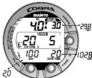
Abbildung 5.9. Ein verbindlicher Sicherheitsstopp. Es wird Ihnen empfohlen, einen verbindlichen Sicherheitsstopp in einer Tiefe zwischen 6 m und 3 m (20 ft und 10 ft) einzulegen. Drücken Sie die Taste TIME, um die alternative Anzeige anzuzeigen.
