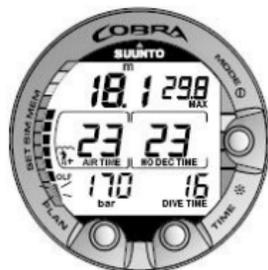
Abbildung 6.16. Das unterste Segment der Balkenanzeige blinkt, um anzuzeigen, dass sich der angezeigte OLF-Wert auf den OTU bezieht.
