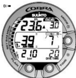
Abbildung 6.9. Dekompressionstauchgang, unterhalb der Dekogrenze. Nach oben weisender Pfeil, blinkende Anzeige ASC TIME und Alarmton weisen Sie auf den Aufstieg hin. Minimale Aufstiegszeit einschließlich Sicherheitsstopp ist 7 Minuten. Dekostufe ist bei 3 m (10 ft).
