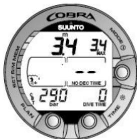
Abbildung 6.1. Der Tauchgang wurde gerade begonnen und es wird keine Restluftzeit angezeigt. Die erste Schätzung der Restluftzeit wird nach 30 - 60 Sekunden angezeigt.
