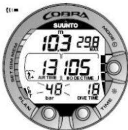
Abbildung 6.5. Flaschendruckwarnungen. Der Druck ist unter 50 bar (725 psi) gesunken. Die Druckanzeige blinkt und ein Signalton wird ausgegeben.
