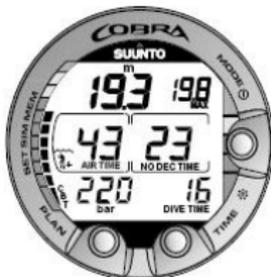
Abbildung 6.2. Tauchanzeige. Die aktuelle Tiefe beträgt 19,3 m (63 ft) und die Nullzeitgrenze beträgt im A0/P1-Modus 23 Minuten. Die maximale Tiefe des Tauchgangs war 19,8 m (65 ft.), die verstrichene Tauchzeit ist 16 Minuten.
