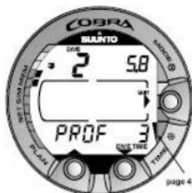
Abbildung 7.8. Logbuch, Seite IV. Tiefenprofil eines spezifischen Tauchgangs.
