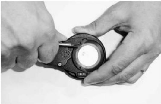
Abbildung 9.1. Öffnen des Sicherungsringes.
