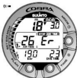
Abbildung 6.12. Dekompressionstauchgang, über Dekostufe. Beachten Sie den nach unten weisenden Pfeil, eine Fehlerwarnung „Er“ und einen Warnton. Sie sollten sofort (innerhalb von 3 Minuten) mindestens auf die Tiefe der Dekostufe abtauchen.
