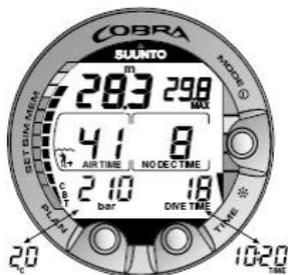
Abbildung 6.3. Tauchanzeige. Der aktuelle Flaschendruck beträgt 210 bar (3.045 psi) und die Restluftzeit 41 Minuten. Die alternative Anzeige der aktuellen Uhrzeit und Temperatur wird nach dem Drücken der Taste TIME für 5 Sekunden angezeigt.
