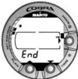
Abbildung 7.4. Logbuch, Ende des Speichers. Der Text END wird zwischen ältestem und aktuellstem Tauchgang angezeigt.
