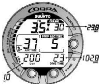
Abbildung 6.11. Dekompressionstauchgang, in Dekozone. Zwei gegeneinander gerichtete Pfeile („Sanduhr-Symbol“). Sie befinden sich in der Dekozone auf 3,5 m (11 ft) und Ihre Mindestaufstiegsdauer beträgt 5 Minuten. Durch das Drücken der Taste TIME werden die alternativen Anzeige aufgerufen.
