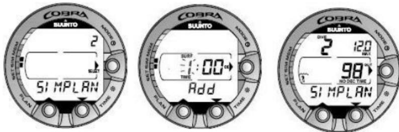
Abbildung 7.13. Planungssimulatoremodus [2 SIMPLAN]. Geben Sie dazu einfach mit den Tasten TIME und PLAN die gewünschte Erhöhung des Oberflächenintervalls (zum aktuell angezeigten Oberflächenintervall) ein. Diese Anzeige wird nur bei wiederholten Tauchgängen angezeigt.
