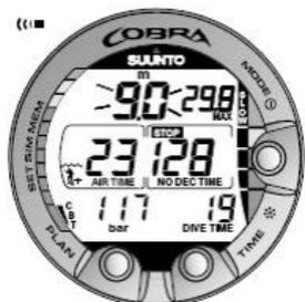
Abbildung 5.8. Anzeige der Aufstiegs geschwindigkeit. Zwei Segmente.
