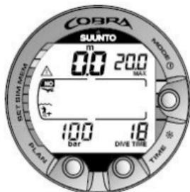
Abbildung 7.1. Surface-Modus. Sie sind nach einem 18-Minuten-Tauchgang, mit einer maximalen Tiefe von 20,0 m / 66 ft. wieder an der Oberfläche. Ihre aktuelle Tiefe ist 0,0 m / 0 ft. Das Flugzeugsymbol weist darauf hin, dass Sie nicht fliegen sollten, und das Achtung-Symbol zeigt an, dass Ihr Oberflächenintervall noch nicht abgelaufen ist.
