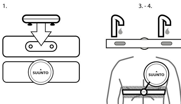
El Smart Sensor se enciende automáticamente al detectar un latido.
