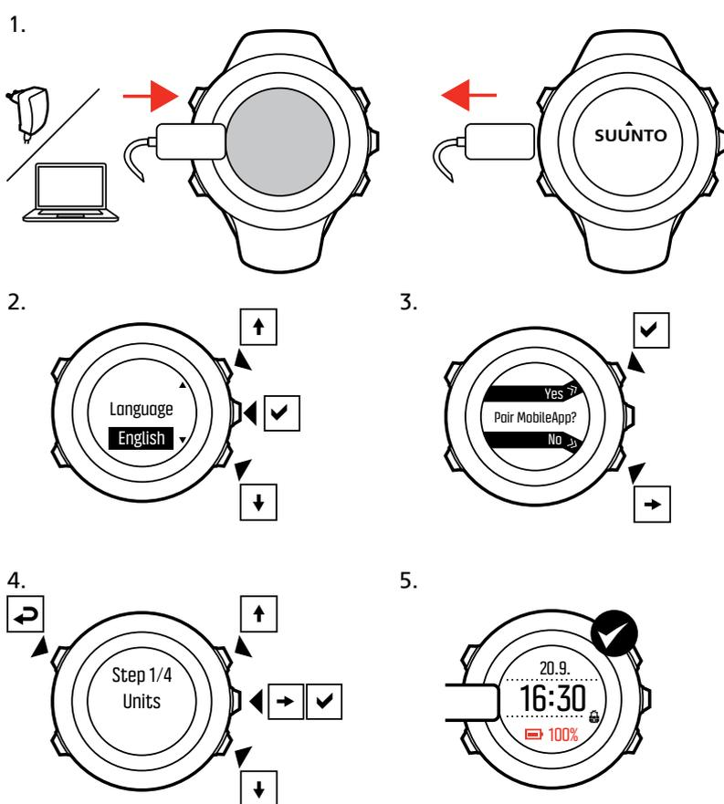
Le rechargement complet d'une batterie vide prend environ 2 à 3 heures. Les boutons sont verrouillés tant que le câble USB est raccordé et connecté à un ordinateur.
