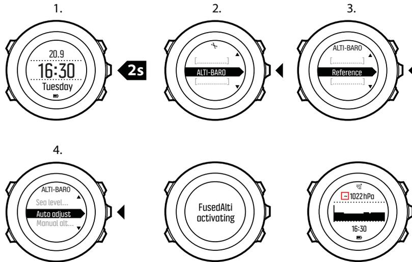
**NOTA:** En buenas condiciones, FusedAlti tarda entre 4 y 12 minutos en activarse. Durante ese tiempo, Suunto Ambit3 Peak muestra la altitud barométrica y se muestra ~ con la lectura de la altitud para indicar que quizá la altitud no sea correcta.
