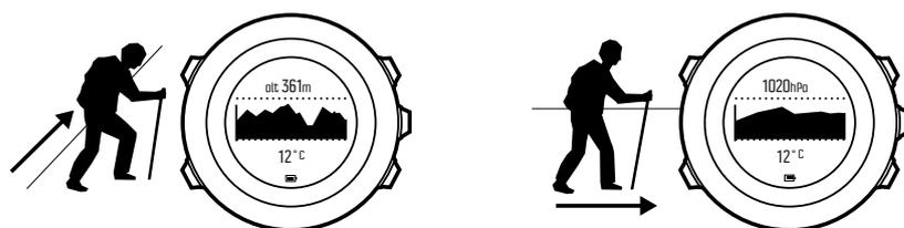
No es posible medir los cambios meteorológicos y de altitud al mismo tiempo, dado que ambos provocan un cambio en la presión barométrica del ambiente. Suunto Ambit3 Peak detecta el movimiento vertical y cambia a la medición de altitud cuando es necesario. Cuando se muestra la altitud, esta se actualiza con un retardo máximo de 10 segundos.
