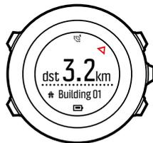
Si estás en movimiento (<4 km/h), el reloj te muestra la dirección hacia el PDI (o punto de referencia si estás recorriendo una ruta) basándose en el GPS.
