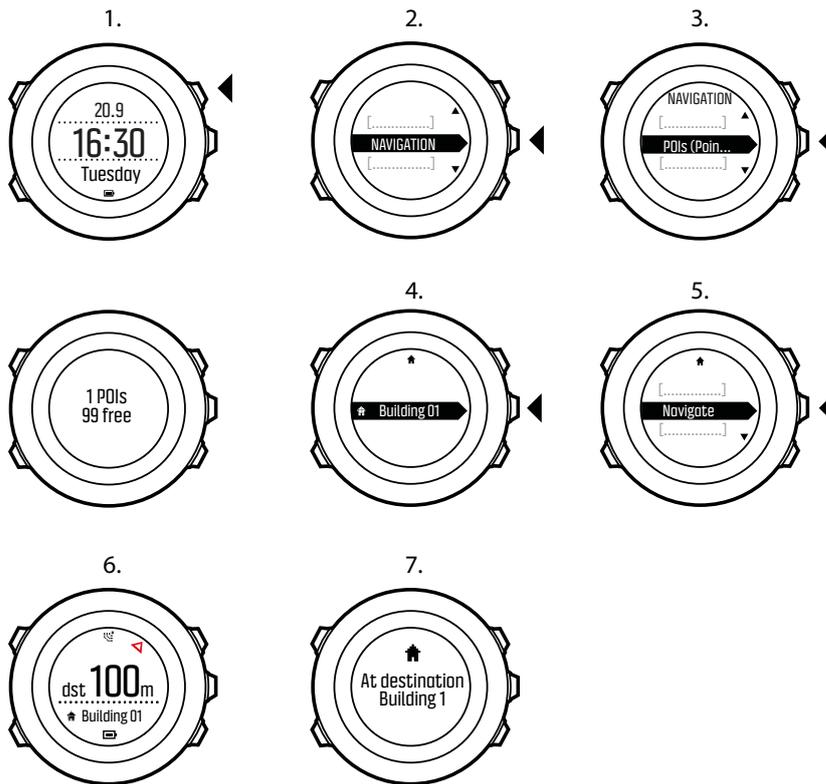
Si estás parado o el movimiento es lento (<4 km/h), el reloj te muestra la dirección hacia el PDI (o punto de referencia si estás recorriendo una ruta) basándose en el rumbo de la brújula.
