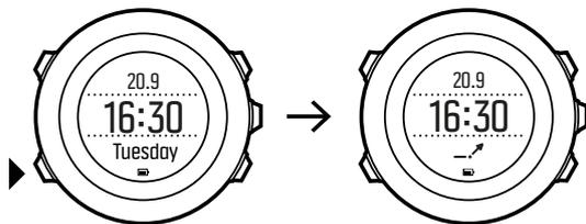
El indicador de tendencia climatológica tiene dos líneas que forman una flecha. Cada línea representa un periodo de tres horas. Un cambio en la presión barométrica superior a 2 hPa (0,59 inHg) durante tres horas provoca un cambio de dirección de la flecha. Por ejemplo:
