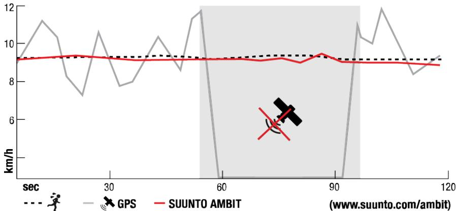
FusedSpeed™ può essere particolarmente utile quando serve grande reattività nella lettura della velocità durante l'allenamento, ad esempio quando si corre su terreni accidentati o durante l'allenamento intervallato. Se si perde temporaneamente il segnale GPS, come ad esempio può accadere in prossimità di grandi edifici, Suunto Ambit2 è in grado di continuare a fornire dati di velocità precisi grazie all'accelerometro calibrato GPS.
