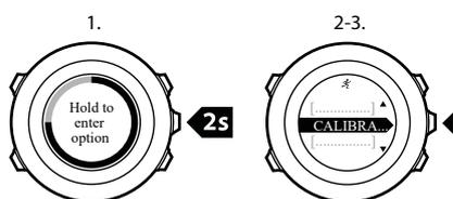
Suunto Ambit2 avvia la calibrazione del POD e ne segnala l'esito positivo o negativo. L'ultima riga del display indica la frequenza attuale utilizzata con il POD. La frequenza precedente viene riportata tra parentesi.
