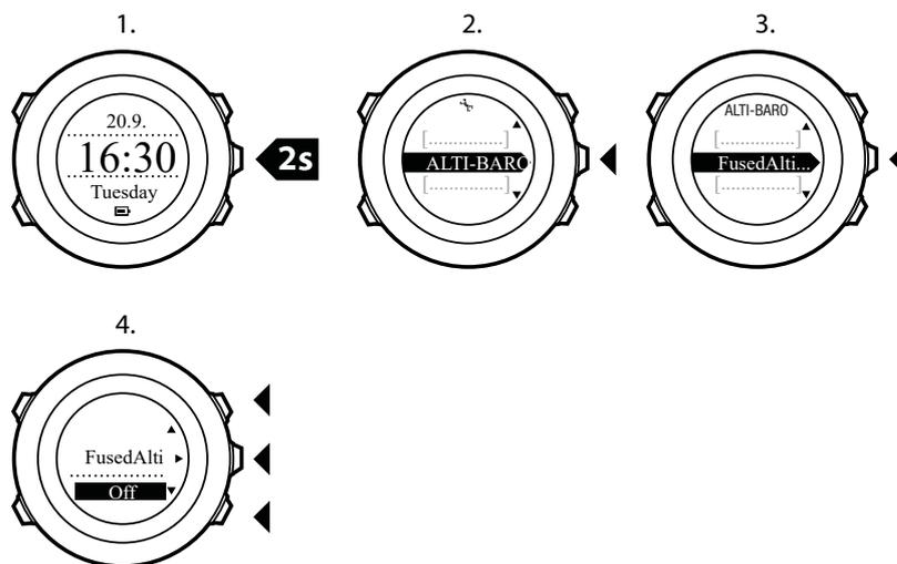
Quando il dispositivo è in modalità **ORA**, è possibile cercare un nuovo riferimento per l'altitudine barometrica con FusedAlti. Viene così attivato il GPS per un massimo di 15 minuti.
