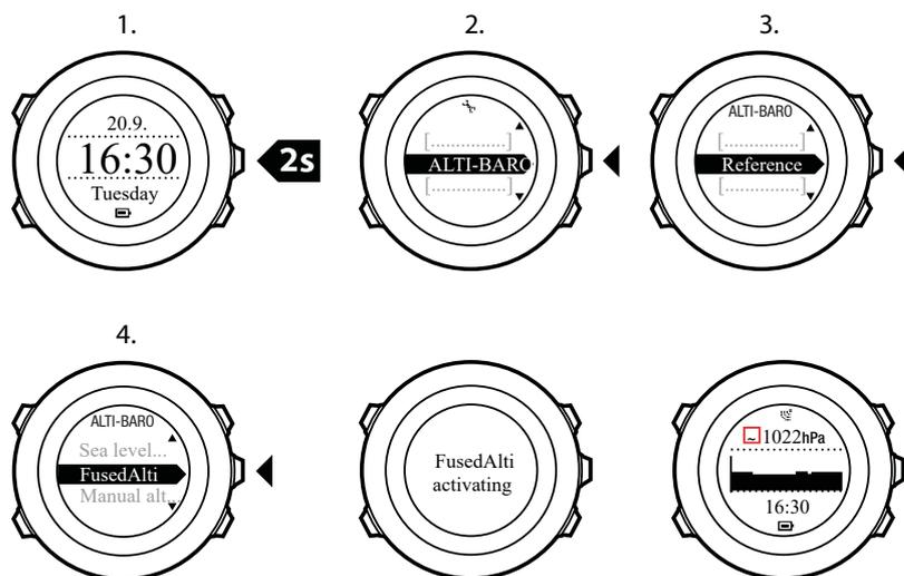
**NOTA:** En buenas condiciones, FusedAlti tarda entre 4 y 12 minutos en activarse. Durante ese tiempo, Suunto Ambit2 muestra la altitud barométrica y se muestra ~ con la lectura de la altitud para indicar que quizá la altitud no sea correcta.
