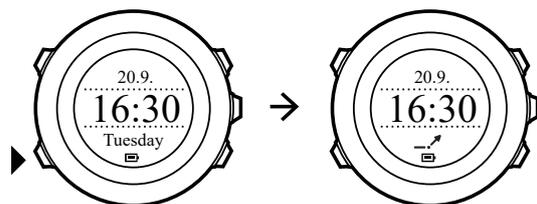
El indicador de tendencia de clima presenta dos líneas que forman una flecha. Cada línea representa un periodo de 3 horas. Un cambio en la presión barométrica superior a 2 hPa / 0,59 inHg durante tres horas provoca un cambio en la dirección de la flecha. Por ejemplo:
