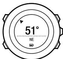
La brújula pasa automáticamente al modo de ahorro de energía después de un minuto. Reactívala con [Start Stop].
