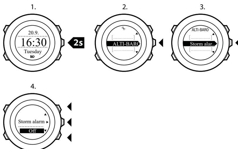
Cuando se active una alarma de tormenta, pulsa cualquier botón para apagarla. Si no se pulsa ningún botón, la alarma se repetirá una vez después de cinco minutos. El símbolo de alarma permanecerá en la pantalla hasta que las condiciones climatológicas se estabilicen (el descenso de presión sea más lento).
