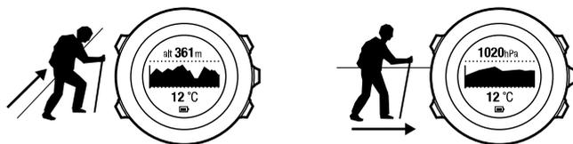
No es posible medir los cambios meteorológicos y de altitud al mismo tiempo, dado que ambos provocan un cambio en la presión barométrica del ambiente. Suunto Ambit2 detecta el movimiento vertical y cambia a la medición de altitud cuando es necesario. Cuando se muestra la altitud, ésta se actualiza con un retardo máximo de 10 segundos.
