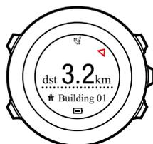
Si estás en movimiento (>4 km/h), el reloj te muestra la dirección hacia del PDI (o punto de referencia si estás recorriendo una ruta), basándose en el GPS.
