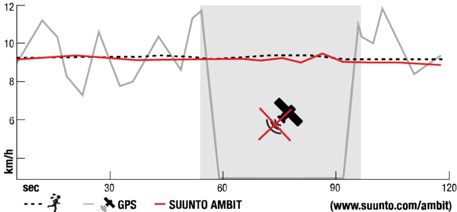
FusedSpeed™ te ofrece máximos beneficios cuando necesites lecturas de velocidad altamente reactivas durante el entrenamiento, por ejemplo, al correr sobre terrenos irregulares o durante un entrenamiento de intervalos. Si pierdes temporalmente la señal GPS, por ejemplo, porque los edificios bloquean la señal, Suunto Ambit2 puede seguir mostrando lecturas de velocidad exactas con ayuda del acelerómetro calibrado por GPS.
