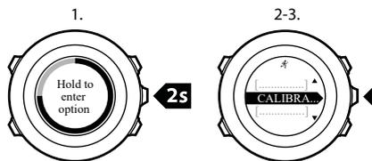
Suunto Ambit2 empieza a calibrar el POD e indica si la calibración se realizó correctamente o si se produjo algún fallo. La fila inferior de la pantalla muestra la frecuencia actual utilizada con el Power POD. La frecuencia anterior se muestra entre paréntesis.
