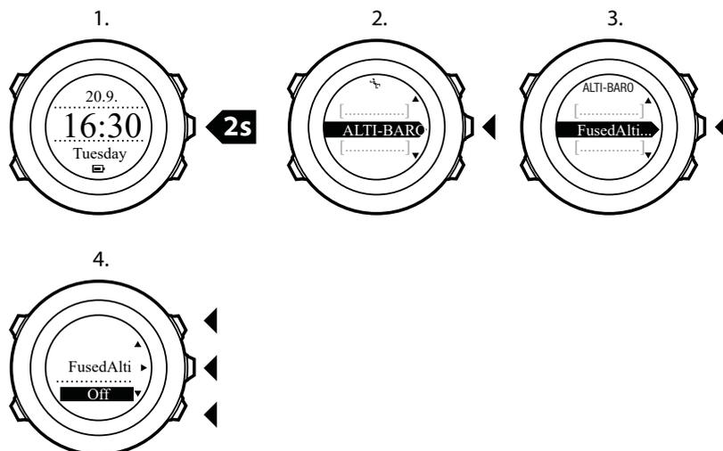
Cuando el dispositivo esté en modo **TIME**, puedes buscar una nueva referencia de altitud barométrica con FusedAlti. Al hacerlo se activa el GPS durante un máximo de 15 minutos.
