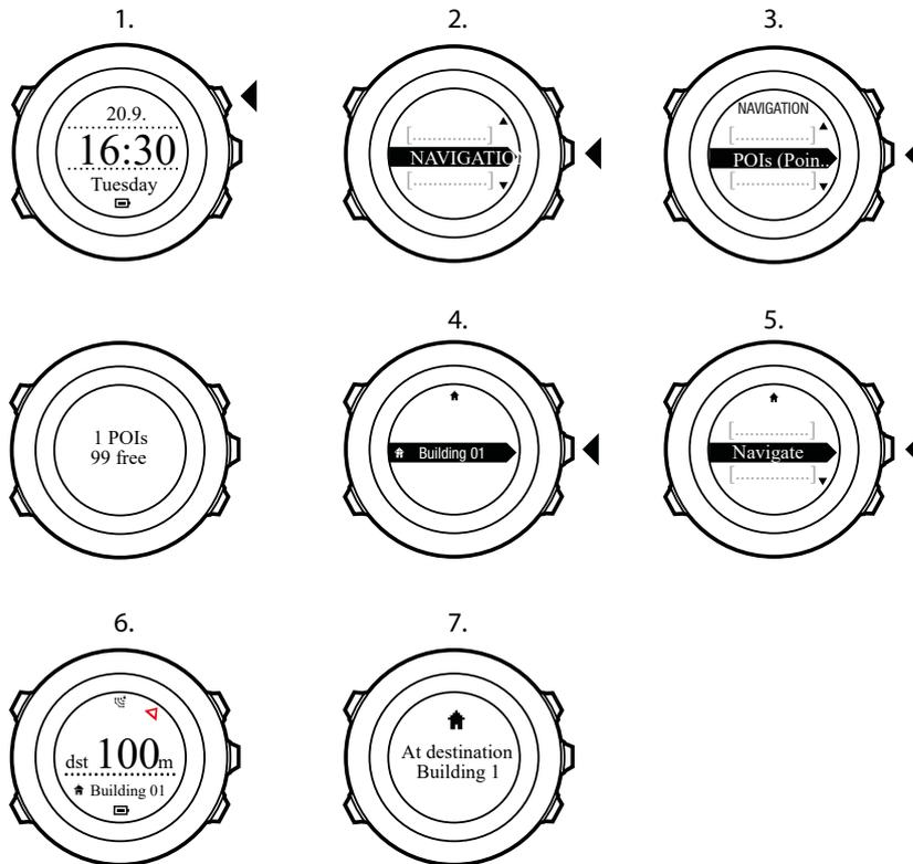
Si estás parado o el movimiento es lento (<4 km/h), el reloj te muestra la dirección hacia del PDI (o punto de referencia si estás recorriendo una ruta), basándose en el rumbo de la brújula.
