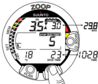
图 3.17. 减压潜水，位于最小减压深度区域。两个彼此互指的箭头（“沙漏”）。您处于最佳的最小减压深度区域 3.5 米 [11 英尺]，且您的最小上升时间是 5 分钟。按“TIME”（时间）按钮切换其它显示屏。
