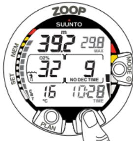
图 3.24. 其它显示内容。按“TIME”（时间）按钮显示当前时间、最大深度、温度、CBT 和 O<sub>2</sub>%。
