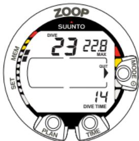
图 4.13. 潜水历史信息。总计潜水次数、潜水时间和最大深度。
