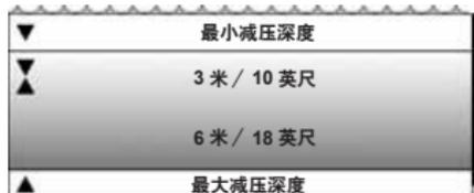
图 3.19. 最小减压深度和最大减压深度区域。建议和强制安全停留区域位于 6 米至 3 米 [20 英尺至 10 英尺] 之间。
