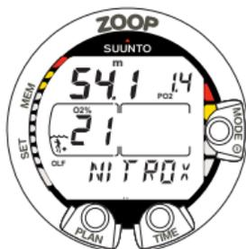
图 3.20. 氮氧显示屏。基于设置 O<sub>2</sub>% (21%) 和 PO<sub>2</sub> (1.4 bar) 的最大深度是 54.1 米 [117 英尺]。
