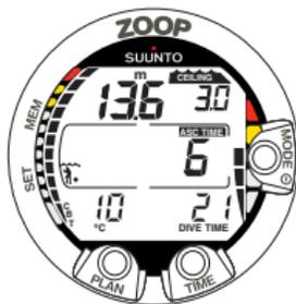
图 3.16. 减压潜水，位于最大减压深度上方。指向上方的箭头已经消失，且 ASC TIME（上升时间）标签已经停止闪烁，这意味着您已位于减压范围内。
