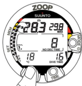
图 3.8. 书签启动。按“PLAN”（计划）按钮，潜水时资料内存中会出现一个书签标志。注意潜水日志符号。
