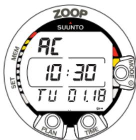
图 2.4. AC 字样表明水接点启用。
