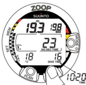
**图 3.7.** 图 3.7 潜水显示屏。在 A0/P1 模式下，当前深度是 19.3 米 [63 英尺]，免减压停留时间限值 23 分钟。本次潜水的最大深度是 19.8 米 [65 英尺]，水温是 18°C [64°F]，已消耗的潜水时间是 16 分钟。按下“TIME”（时间）按钮后 5 秒钟切换当前时间显示屏，当前时间是 10:20 [上午 10:20]。
