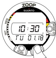
Рис. 2.1.; Дисплей текущего времени Нажатие кнопки PLAN или TIME активирует дисплей.
