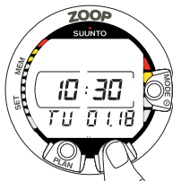
Fig. 2.1. Visor de apresentação de hora. Premir o botão PLAN ou TIME activa o visor.
