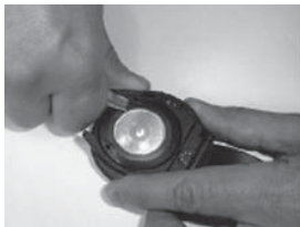
Fig. 5.30. Het losdraaien van de bevestigingsring.
