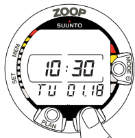
Fig. 2.1. Het tijdsdisplay. Het indrukken van de PLAN of TIME knop activeert het display.
