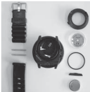
Fig. 5.1. Componenti dello strumento. Il codice dopo il nome del componente è il codice ricambio del pezzo.
