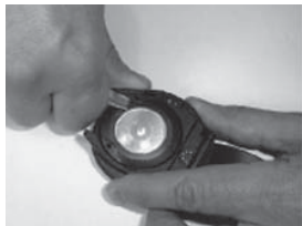
Fig. 5.29. Apertura del anillo de bloqueo.
