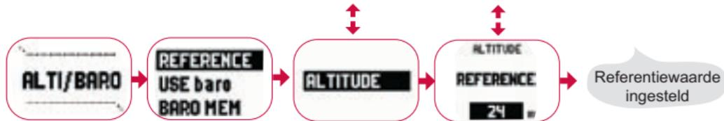
**OPMERKING:** Wanneer GPS is ingeschakeld, vindt u de referentiehoogte via de positieweergave in het menu Function.
