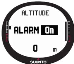
Quando l'allarme si attiva, parte il segnale sonoro, si accende la retroilluminazione e il messaggio 'ALTITUDE ALARM' viene visualizzato insieme all'altitudine corrente. Quando l'allarme suona, per tacitarlo premere uno qualsiasi dei tasti del Suunto X9. L'allarme riparte nuovamente quando l'apparecchio va 50 metri sopra o sotto l'altitudine impostata.
