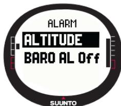
La funzione Altitude permette di impostare un allarme che indica quando si è raggiunta l'altitudine impostata.
