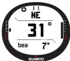
**Rilevamento (bea):** Quando si naviga su una rotta del menu Navigation, la terza selezione rapida visualizza il rilevamento fino al punto di instradamento successivo. Nel caso non sia stata attivata alcuna rotta ed il GPS sia on, il display delle selezioni rapide visualizzerà il rilevamento relativo alla posizione di partenza (punto in cui il GPS o un'attività erano on). In caso di GPS spento, la selezione rapida visualizzerà il punto dell'ultimo rilevamento effettuato.
