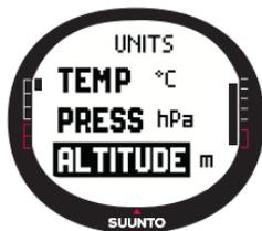
L'impostazione Altitude definisce l'unità di misura utilizzata per visualizzare l'altitudine. Le opzioni sono metri (m) e piedi (ft).
