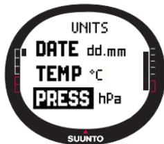
L'impostazione Press definisce l'unità di misura utilizzata per visualizzare la pressione barometrica. Le opzioni sono hPa e inHg.
