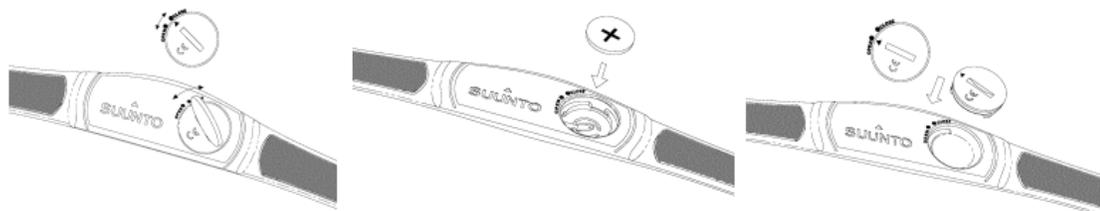
3. Retirez le couvercle du logement de la pile. Vérifiez que le joint et les surfaces sont propres et secs. N'étirez pas le joint.
