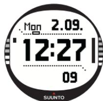
Cuando el GPS se activa, el indicador de recepción del GPS aparece en la línea punteada horizontal superior de la pantalla. Una vez que el GPS se activa pero no recibe satélites, aparecerá parpadeando un punto rectangular vacío. Cuando el GPS tiene una posición establecida, se muestran de 1 a 5 puntos rectangulares llenos. La cantidad depende de la calidad de la recepción. Más puntos indican mejor cobertura de satélite y señal de recepción.
