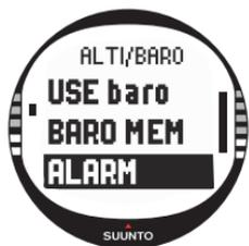
Con la función Alarm (Alarma) podrá definir dos alarmas diferentes, de altitud y de tiempo atmosférico. Cuando haya ajustado una alarma, su símbolo aparecerá en la pantalla.
