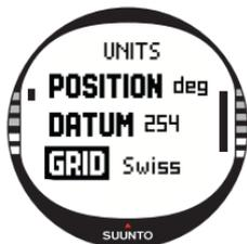
El ajuste Grid (Coordenadas cartográficas) define las coordenadas que está utilizando. (Para obtener más información sobre las diferentes coordenadas, consulte el apéndice Lista de coordenadas cartográficas locales.)
