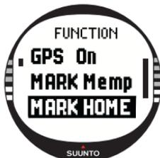
**NOTA:** El *Suunto X10* utiliza el GPS para guiarle mientras se está moviendo. Cuando permanece quieto, la marcación de la brújula le muestra la dirección hacia la posición marcada.
