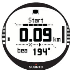
**NOTA:** En una navegación de ruta normal, la unidad cambia automáticamente al siguiente punto de control cuando llega a un radio de 30 metros del punto de control o pasa a una distancia superior a 100 metros de la línea perpendicular a la ruta que pasa por el punto de control.
