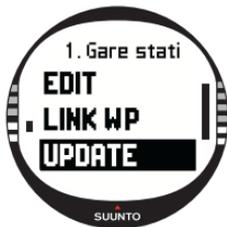
y el indicador de potencia de señal GPS muestra 5 barras, la ubicación se actualiza automáticamente. También puede aceptar una exactitud menor presionando ENTER.
