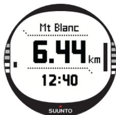
**Tiempo hasta el punto de control (ttw):** Muestra el tiempo de viaje estimado hasta el siguiente punto de control basado en la velocidad actual.
