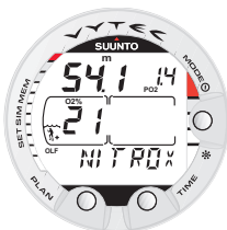
Fig. 3.21. Nitrox display. De maximum diepte, gebaseerd op 21% O_2 en een PO_2 van 1.4 bar is 54.1 meter.
