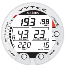
Fig. 3.8. Duikdisplay. De huidige diepte is 19.3 m [63 ft] en de resterende geen-decompressietijd is 23 minuten in stand A0/P1. De maximumdiepte voor deze duik was 19.8 m [65 ft], de verstreken duiktijd is 16 minuten.
