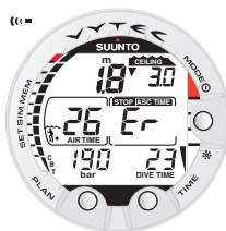
Fig. 3.19. Decompressieduik, boven het de-compressieplafond. Let op de naar beneden wijzende driehoek en de Er-waarschuwing en het alarmsignaal. U moet nu (binnen 3 minuten) afdalen tot beneden het decompressieplafond.
