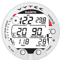
Fig. 3.10. Een aandachtspunt of annotatie wordt in het profielgeheugen geplaatst door op de PLAN knop te drukken. Let op het logboek-symbooltje.
