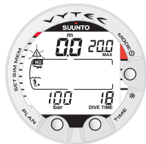
Fig. 3.29. Het display aan de oppervlakte. U bent boven gekomen na een duik van 18 min. op 20.0 m [66 ft]. De huidige diepte is 0.0 m. Het vliegtuigsymbool wil zeggen dat er een vliegverbod geldt en het knipperende attentie-symbool houdt in dat u aan-geraden wordt om uw oppervlakte-interval te verlengen.
