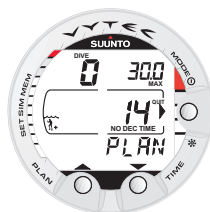
Fig. 3.6. Duikplanning. De duikplanner wordt aangegeleid met de tekst PLAN. De geen-decompressielimiet (nultijd) voor een duik op 30.0 m is 14 minuten, in stand A0/P1.
