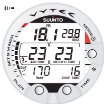
Fig. 3.26. OLF grafiek betreft in dit geval de OTU waarde. Het onderste segment knippert.
