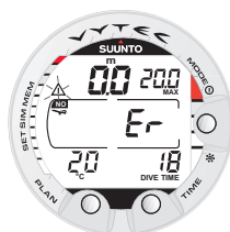
Fig. 3.32. De oppervlaktestand na het overslaan van een decompressiestop. De 'Er'-waarschuwing op het display wil zeggen dat u langer dan drie minuten boven het decompressieplafond heeft doorgebracht. U mag minimaal 48 uur niet duiken.
