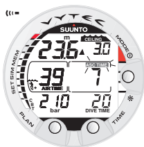
Fig. 3.16. Decompres-sieduik, beneden de ondergrens. De omhoog wijzende driehoek en het knipperende ASC TIME-symbooltje geven aan dat u moet opstijgen. De minimaal benodigde tijd om een opstijging te maken, inclusief deocon veiligheidsstops is 7 minuten. Het plafond ligt op 3 m.
