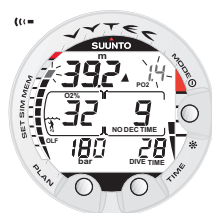
Fig. 3.24. PO_2 en OLF displays. Er klinkt een waarschuwing wanneer de PO_2 groter is dan 1.4 bar (of een andere waarde als deze veranderd is) en wanneer de OLF 80% bereikt.
