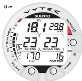
Abb. 3.26. Der Wert  $O_2\%$  überschreitet den CNS-Wert. Das unterste Segment beginnt zu blinken und ein akustischer Alarm ertönt.
