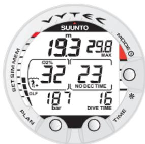
Abb. 3.22. Tauchen im Nitrox-Modus. O<sub>2</sub>% ist auf 32% eingestellt.
