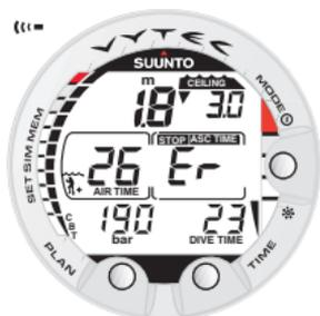
Abb. 3.19. Dekompressionsstauung oberhalb der Dekompressionsstufe. Beachten Sie den abwärts gerichteten Pfeil und die „Er“-Warnung. Ausserdem hören Sie einen akustischen Alarm. Sie sollten sofort (innerhalb von 3 Minuten) mindestens auf die vorgeschriebene Deko-Stufe abtauchen.
