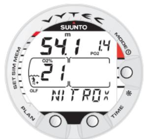
Abb. 3.21. Nitrox-Anzeige. Die maximale Tiefe basierend auf den Einstellungen O<sub>2</sub>% (21%) und PO<sub>2</sub> (1,4 bar) beträgt 54,1 m [177ft].
