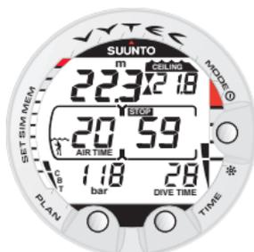
Abb. 3.15b Deep Stop. Die Pfeile weisen darauf hin, dass Sie sich in der Deep Stop-Tiefe befinden. Sie müssen noch 59 Sekunden auf der Tiefe bleiben, um den Deep Stop zu beenden.
