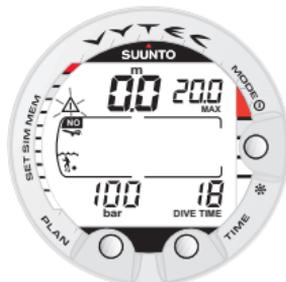
Abb. 3.29. Anzeige im Oberflächenmodus. Sie haben einen 18-minütigen Tauchgang durchgeführt, dessen maximale Tiefe 20,0m [66ft] betrug. Ihre aktuelle Tiefe ist 0,0m [0ft]. Das Flugverbots-Symbol zeigt, dass Sie nicht fliegen sollten und das ACHTUNG-Symbol weist Sie darauf hin, dass Sie Ihre Oberflächenpause wegen des Auftretens von Mikrobäschen verlängern sollten.
