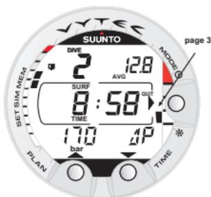
Abb. 4.9. Logbuch, Seite III. Oberflächenintervall, durchschnittliche Tiefe und Luftverbrauch, angezeigt durch ÄP.
