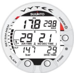
Abb. 3.23. Tauchen im Nitrox-Modus. Nachdem die Restluftzeit weniger als 30 Minuten beträgt, wird die Anzeige O<sub>2</sub>% durch die Anzeige der Restluftzeit ersetzt.
