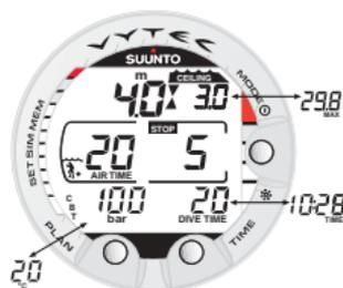
Fig. 3.14. Een Verplichte Veiligheidsstop. U wordt geacht om een Verplichte Veiligheidsstop te maken in het gebied tussen 6 en 3 meter diepte [20 ft en 10 ft]. Door het indrukken van de TIME knop kunt u het alternatieve display oproepen.
