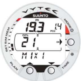
Fig. 3.27. Wisselen van gasmengsel. Het huidige gasmengsel is MIX1 (21%). Scroll door de beschikbare gasmengsels door op de PLAN of TIME knop te drukken. Activeer het nieuwe mengsel met MODE (OK).
