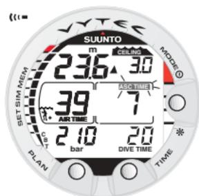
Fig. 3.16. Decompressieduik, beneden de ondergrens. De omhoog wijzende driehoek en het knipperende ASC TIME-symboolje geven aan dat u moet opstijgen. De minimaal benodigde tijd om een opstijging te maken, inclusief decoden veiligheidsstops is 7 minuten. Het plafond ligt op 3 m.
