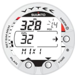
Fig. 4.28. Het instellen van het hoofdmengsel MIX1. Het % O<sub>2</sub> is 32% en de maximale PO<sub>2</sub> is 1.4 bar. De maximumdiepte voor dit gasmengsel is 32.8 meter [107 ft]. Gebruik de scroll-knoppen om het percentage O<sub>2</sub> en de maximale PO<sub>2</sub> in te stellen. Bevestig uw ingave met MODE (OK).
