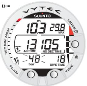
Fig. 3.12. Flesdrukwaarschuwing. De flesdruk is lager dan 50 bar [725 psi]. De weergave van de flesdruk knippert en er klinkt een waarschuwingssignaal.
