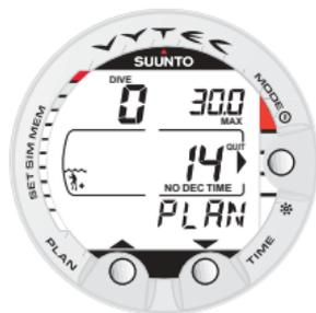
Fig. 3.6. Duikplanning. De duikplanner wordt aangegeuid met de tekst PLAN. De geen-decompressie-tijd (nultijd) voor een duik op 30.0 m is 14 minuten, in stand A0/P1.
