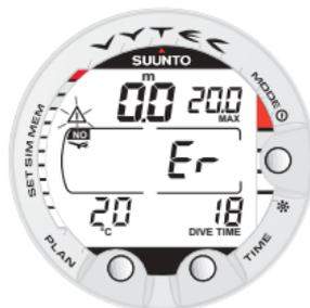
Fig. 3.32. De oppervlakes-tand na het overslaan van een decompressiestop. De 'Er'-waarschuwing op het display wil zeggen dat u langer dan drie minuten boven het decompressieplafond heeft doorgebracht. U mag minimaal 48 uur niet duiken.
