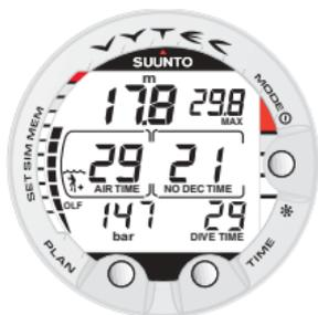
Fig. 3.23. Duiken in de Nitrox modus. De resterende luchtijd is korter dan 30 minuten. Het  $O_2$  is vervangen door de resterende luchtijd.
