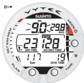
Fig. 3.13. Stijgsnelheidsmeter. Een knipperende weergave van de diepte, SLOW en vier segmenten op de stijgsnelheidsmeter: de stijgsnelheid is groter dan 10 m/min. Dit is een waarschuwing om uw opstijging af te remmen! Het STOP-symbool betekent dat u een Verplichte Veiligheidsstop dient te maken wanneer u 6 meter [20 ft] diepte bereikt.
