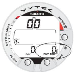
Fig. 3.5. Waarschuwing voor te lage batterijspanning. Het batterijsymbool geeft aan dat de batterijspanning te laag is en de batterij vervangen moet worden.
