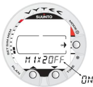
Fig. 4.29. Het instellen van de overige gasmengsels (MIX2, MIX3). MIX2 is uitgeschakeld. Druk op de scrollknoppen om MIX2 in- of uit te schakelen. Druk vervolgens op MODE (OK) om wijzigingen te bevestigen.
