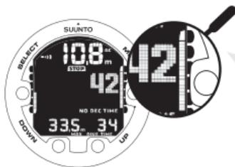
RETRO-ILUMINAÇÃO ACTIVADA, ALARME E UM GRÁFICO DE BARRAS DE SUBIDA INTERMITENTE INDICA QUE ESTÁ A SUBIR MAIS RAPIDAMENTE DO QUE 10 M/MIN. É AVISADO PARA FAZER UMA PARAGEM DE SEGURANÇA OBRIGATÓRIA QUANDO ATINGE UMA PROFUNDIDADE DE 6 M.
