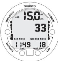
O BOTÃO DOWN ALTERA ENTRE A PROFUNDIDADE MÁXIMA, A HORA ACTUAL E PRESSÃO DO TANQUE.
