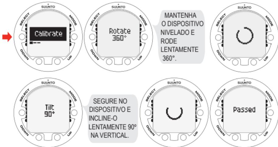
Se a calibragem falhar várias vezes num local, é possível que esteja numa área com fontes de magnetismo como, por exemplo, grandes objectos metálicos, linhas ou aparelhos eléctricos. Desloque-se para outro local e tente calibrar novamente a bússola. Se a calibragem continuar a falhar, contacte um centro de assistência técnica autorizado da Suunto.
