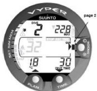
图 7.6. 第 II 页的潜水日志。主要潜水相关数据。
