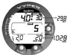
图 5.9. 强制安全停留。建议您在 6 米和 3 米/20 英尺和 10 英尺的深度区进行强制安全停留。按 TIME（时间）按钮来查看其他显示。
