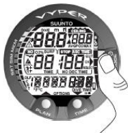
图 5.5. 启动 I。所有部分将显示。
