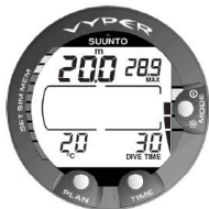
图 6.15. 仪表模式。在潜水中将显示当前深度、最大深度、潜水时间、剩余空气时间和上升速率指示器。
