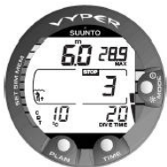
图 5.8. 上升速率指示器。两个区段。
