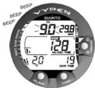
图 6.4. 上升速率指示器。深度读数闪烁，SLOW（减速）和四个区段显示：上升速率高于 10 米/分钟/33 英尺/分钟。注意要减速！STOP（停止）符号表示当您到达 6 米/20 英尺深度时建议进行强制安全保留。
