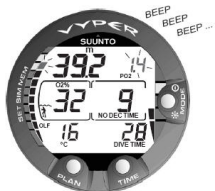
图 6.12. 氧气分压和 OLF 显示。如果氧气分压大于 1.4 bar 或设置值，以及/或者 OLF 到达 80% 的限值，声音警报将响起。
