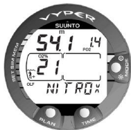
图 6.11. 高氧显示。基于设置 02% (21%) 和 PO 2 (1.4 bar) 的最大深度为 54.1 米/177 英尺。
