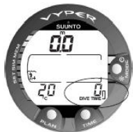
图 5.7. 低电量警告。电池符号指示电量低，建议更换电池。
