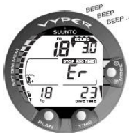
图 6.10. 最小减压深度以上位置的减压潜水。注意指向下方的箭头、Er 警告和声音警报。您应即刻（3 分钟以内）下降到最小减压深度或以下。
