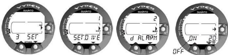
图 5.2. 设置潜水时间警报。按滚动按钮来更改警报的开/关状态以及设置潜水时间值。
