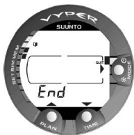
图 7.4. 内存结束时的潜水日志。在最早和最近的潜水记录之间，将显示“END” (结束) 文字，以示区分。
