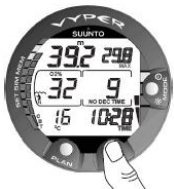
图 6.13. 其他显示屏。按下 TIME（时间）按钮将显示当前时间、最大深度和 CBT。
