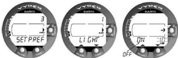
图 4.8. 设置背光按时。按滚动按钮来更改背光的开/关状态以及设置时间值。
