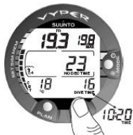
图 6.2. 潜水显示屏。当前深度为 19.3 米/63 英尺，免减压停留时间限制在 A0/P1 模式中为 23 分钟。本次潜水中的最大深度为 19.8 米/65 英尺，已消耗潜水时间为 16 分钟。按下 TIME（时间）按钮后，当前时间 10:20 [10:20 am] 将显示 5 秒钟。
