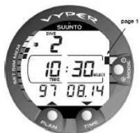
图 7.5. 第 I 页的潜水日志。滚动显示具体潜水的不同页面。
