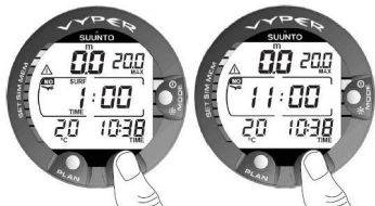
图 7.2. 水面间隔、水面时间和禁飞时间显示：按下 TIME（时间）按钮一次，将出现水面时间显示屏，按下 TIME（时间）按钮两次，将显示以飞机符号指示的禁飞时间显示屏。
