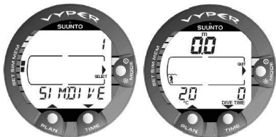
图 7.12. 潜水模拟器模式 [1 SIMDIVE]。通过按向下箭头（时间）按钮下降，通过按向上箭头（计划）按钮上升。
