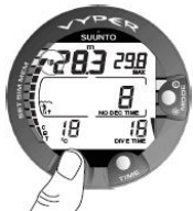
图 6.3. 潜水显示屏。在潜水过程中按“PLAN”（计划）按钮，书签注释将位于资料内存中。注意潜水日志符号。
