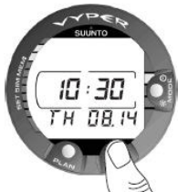
图 3.1. 计时显示屏。按 PLAN（计划）或 TIME（时间）按钮可启用显示屏。
