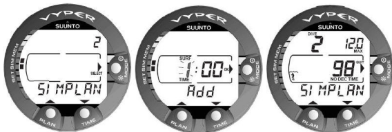
图 7.13. 潜水计划模拟器模式 [2 SIMPLAN]。通过按 TIME（时间）和 PLAN（计划）按钮，可添加所需水面间隔增量（添加到当前所显示的水面间隔）。此显示屏只显示重复潜水。
