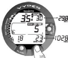
图 6.9. 处于最小减压深度区域的减压潜水。两个对指箭头（“沙漏”）。您处于 3.5 米/11 英尺的最佳最小减压深度区域，您的最小上升时间为 5 分钟。按 TIME（时间）按钮启用其他显示。
