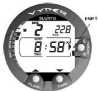
图 7.7. 第 III 页的潜水日志。水面间隔时间和平均深度。
