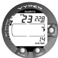
图 7.10. 潜水历史信息。潜水的总次数、潜水小时和最大深度。
