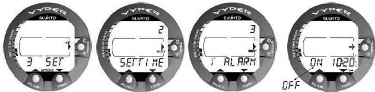
图 4.7. 调节日常警报设置模式 [3 T ALARM]
