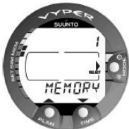
Figur 4.2. Bläddra mellan lägesalternativen genom att trycka på uppåt- och nedåtknapparna.
