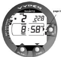
Figur 7.7. Logg, sida III. Ytintervalltid och genomsnittsdjup.
