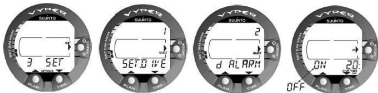
Figur 5.2. Ställa in dyktidslarm Tryck på bläddringsknapparna för att växla mellan av och på samt ställa in dyktiden.
