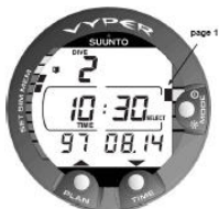
Figur 7.5. Logg, sida I. Bläddra mellan olika sidor med information om ett specifikt dyk.
