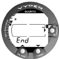
Figur 7.4. Logg, minnets slut. Texten END visas mellan det äldsta och det senaste dyket.
