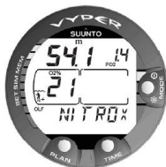
Figur 6.11. Nitrox-display. Maxdjup baserat på inställda värden för O_2 % (21 %) och PO_2 (1,4 bar) är 54,1 m/177 fot.
