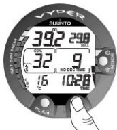
Figur 6.13. Alternativ display. Om du trycker på TIME-knappen visas aktuell tid, maxdjup och CBT.
