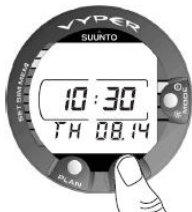
Figur 3.1. Display för tidsvisning. Tryck på PLAN- eller TIME-knappen för att aktivera displayen.
