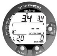
Figur 6.1. Dyket har just påbörjats.
