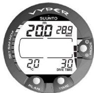
Figur 6.15. GAUGE-läget. Aktuell djup, maxdjup, dyktid, återstående lufttid och indikator för uppstigningshastighet visas under dyket.
