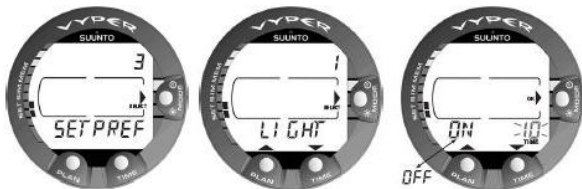
Figur 4.8. Inställning för bakgrundsbelysningstid. Tryck på bläddringsknapparna för att växla mellan av och på samt ställa in tidsvärde för bakgrundsbelysningen.
