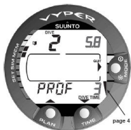
Figur 7.8. Logg, sida IV. Profil för ett specifikt dyk.
