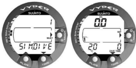
Figura 7.12. Modo de simulador de mergulho [1 SIMDIVE] Descer ao premir o botão com a seta a apontar para baixo (TIME) e subir ao premir o botão com a seta a apontar para cima (PLAN).
