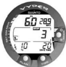
Figura 5.8. Indicador da velocidade de subida. Dois segmentos.
