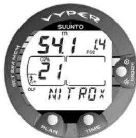
Figura 6.11. Indicação de Nitrox. A profundidade máxima baseada em  $O_2\%$  (21%) e  $PO_2$  (1,4 bar) é de 54,1 m/177 pés.
