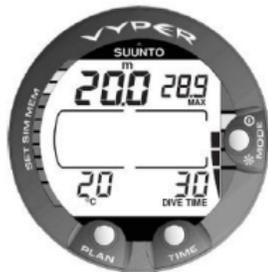
Figura 6.15. O modo GAUGE. A profundidade actual, a profundidade máxima, o tempo de mergulho, o tempo de ar restante e indicador da velocidade de subida são apresentados durante o mergulho.
