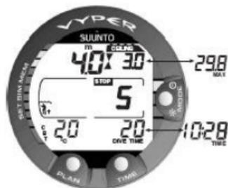
Figura 5.9. Uma Paragem de Segurança Obrigatória. É aconselhado a realizar uma Paragem de Segurança Obrigatória na zona de profundidade entre 6 m e 3 m/20 pés e 10 pés. Prima o botão TIME para ver a apresentação alternativa.
