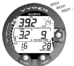
Figura 6.12. Indicações da pressão parcial de oxigénio e OLF. Há um alarme sonoro quando a pressão parcial de oxigénio for superior a 1,4 bars ou ao valor definido, e/ou quando OLF tiver atingido o limite 80%.
