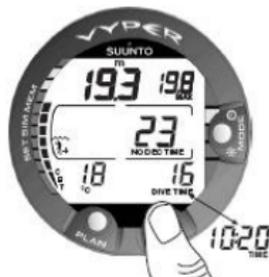
Figura 6.2. Informação de mergulho. A profundidade actual é de 19,3 m /63 pés e o limite de paragem de não-descompressão é de 23 minutos no modo A0/P1. A profundidade máxima durante este mergulho foi de 19,8 m/65 pés, o tempo de mergulho decorrido é de 16 minutos. A hora actual 10:20 [10:20 am] é mostrada durante 5 segundos depois de premir o botão TIME.
