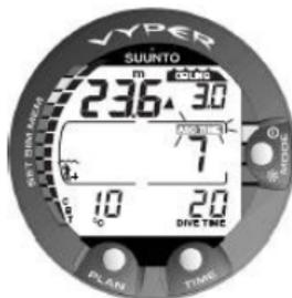
Figura 6.7. Mergulho de descompressão, abaixo do nível inferior. A seta a apontar para cima, a informação intermitente ASC TIME e um alarme sonoro indicam-lhe para subir. O tempo de subida total mínimo, incluindo a paragem de segurança, é de 7 minutos. O tempo limite superior é de 3 m/10 pés.
