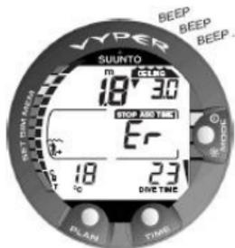
Figura 6.10. Mergulho de descompressão, acima do limite superior. Note uma seta a apontar para baixo, um Aviso de erro (Er) e um alarme sonoro. Deve descer imediatamente (no prazo de 3 minutos) para o, ou abaixo do, limite superior.
