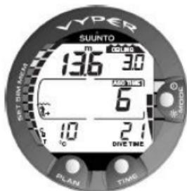
Figura 6.8. Mergulho de descompressão, acima do nível inferior. A seta a apontar para cima desapareceu e a informação ASC TIME parou de piscar, o que significa que está no intervalo de descompressão.
