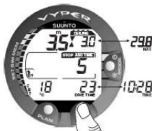
Figura 6.9. Mergulho de descompressão, na zona do limite superior. Duas setas a apontarem uma para a outra (“ampulheta”). Está na zona de limite superior óptima a 3,5 m/11 pés, e o tempo mínimo de subida é de 15 minutos. Premir o botão TIME activará uma apresentação alternativa.
