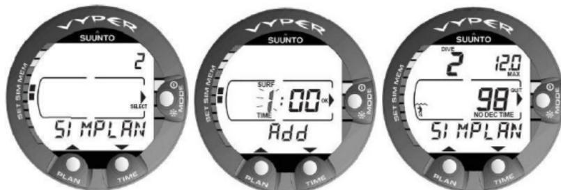
Figura 7.13. Modo de simulador de planeamento de mergulho [2 SIMPLAN] Adicionar o incremento do intervalo de superfície pretendido (ao intervalo de superfície actual) através do botões TIME e PLAN. Este visor só é apresentado para mergulhos repetitivos.
