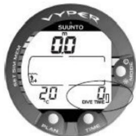
Figura 5.7. Aviso de bateria fraca. O símbolo de bateria indica que a bateria está fraca, sendo recomendada a sua substituição.
