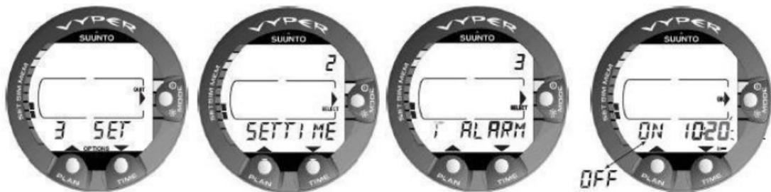
Figura 4.7. Ajustar o modo de definição do alarme diário [3 T ALARM]
