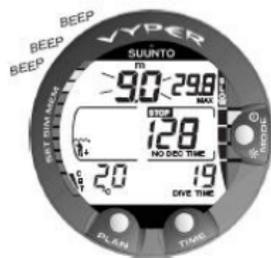
Figura 6.4. Indicador da velocidade de subida. A leitura da profundidade intermitente, SLOW e quatro segmentos são mostrados: A velocidade de subida é superior a 10 m/min/33 pés/min. Deve reduzir a velocidade! O sinal STOP significa que é aconselhado a realizar uma paragem de segurança obrigatória ao atingir a profundidade de 6 m/20 pés.
