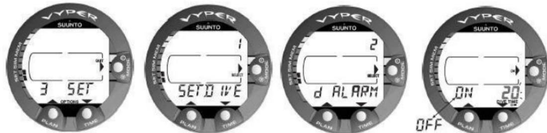
Figura 5.2. Definir o alarme do tempo de mergulho. Prima os botões de navegação para ligar/desligar o alarme e para definir o valor do tempo de mergulho.
