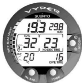
Figura 6.14. O segmento mais baixo do gráfico de barras fica intermitente para indicar que o valor OLF apresentado se refere a OTU.
