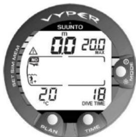
Figura 7.1. Indicação Surface. Chegou à superfície a partir de um mergulho de 18 minutos, cuja profundidade máxima foi de 20,0 m/66 pés. A profundidade actual é de 0,0 m/0 pés. O símbolo de avião indica que não deve voar e o símbolo de atenção ao mergulhador indica que deve prolongar o seu tempo de intervalo de superfície.
