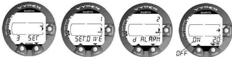
Rysunek 5.2. Ustawianie alarmu czasu nurkowania. Do uruchamiania/wyłączenia alarmu oraz wprowadzania czasu nurkowania służą przyciski przewijania.
