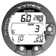
Rysunek 5.8. Wskaźnik prędkości wynurzania. Dwa segmenty.
