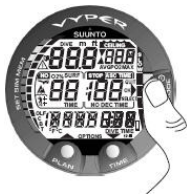
Rysunek 5.5. Uruchamianie I. Wszystkie segmenty widoczne.
