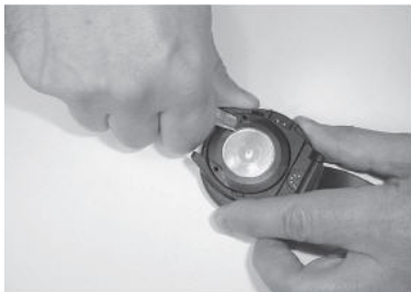
Rysunek 9.1. Zdejmowanie pierścienia zabezpieczającego.
