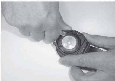
Figura 9.1. Apertura dell'anello di bloccaggio.
