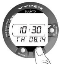
Figura 3.1. Display dell'orologio. Premere il pulsante PLAN o TIME per attivare il display.
