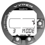
Figura 4.1. Principali opzioni della modalità basata sul menu [3 MODE]
