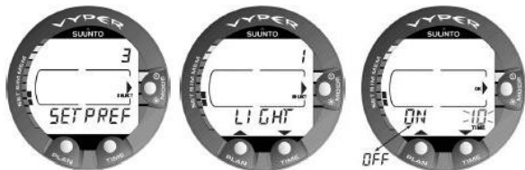
Figura 4.8. Impostazione della Retroilluminazione programmata (Backlight On Time). Premere i pulsanti di scorrimento per accendere/spegnere la retroilluminazione e impostare il valore relativo all'ora.
