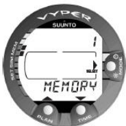
Figura 4.2. Scorrere le opzioni di modalità premendo i pulsanti freccia su/giù.
