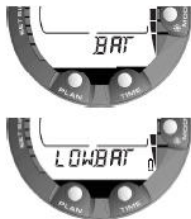
Figura 5.6. Avvio II. Indicatore di carica della batteria.
