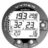
Figura 6.14. Il grafico a barre più in basso lampeggia per indicare che il valore OLF mostrato si riferisce all'OTU.
