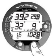
Figura 6.13. Display alternativo. Premendo il pulsante TIME si visualizzano l'ora attuale, la profondità massima e il CBT.
