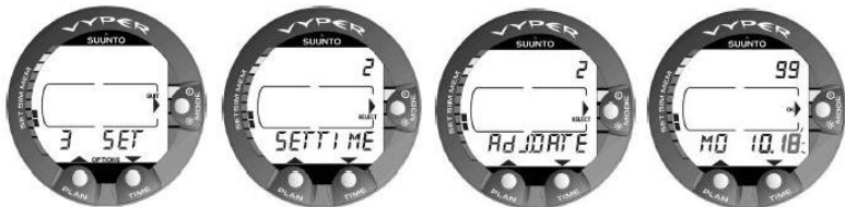
Figura 4.6. Regolazione della modalità di Impostazione della data [2 AdJ DATE].
