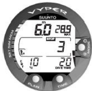
Figura 5.8. Indicatore della velocità di risalita. Due segmenti.
