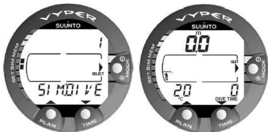
Figura 7.12. Modalità Simulatore di immersione [1 SIMDIVE]. Scendere premendo il pulsante freccia in giù (TIME) e salire premendo il pulsante freccia in su (PLAN).
