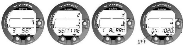
Figura 4.7. Regolazione della modalità di Impostazione dell'allarme giornaliero [3 T ALARM]
