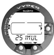
Kuva 7.11. Sukellussimulaation vaihtoehdot [2 SIMUL]
