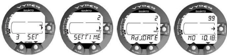
Kuva 4.6. Päivämäärän asetustilan muuttaminen [2 Adj DATE].
