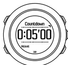
Il tempo preimpostato per il conto alla rovescia è di cinque minuti. È possibile regolare il tempo premendo [VIEW].
