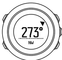
È possibile cambiare le informazioni del display della bussola nel menu opzioni, andando su **Generali » Formati » Unità bussola**. Selezionare il valore primario nel centro del display della bussola: gradi, mil o cardinali.
