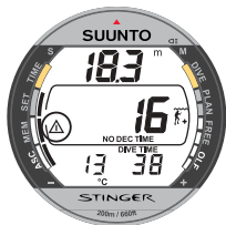
Bild 3.7. Aktivering av bokmärke. En anteckning, eller ett bokmärke, placeras i minnet för dykprofil om du trycker på S under dyket (en varningssymbol visas).
