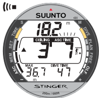
Bild 3.17. Dekompressionsdyk, under etappgolvet. Uppåtriktad pil, blinkande ASC TIME och en ljudsignal anger att du ska gå uppåt. Minsta sammanlagda uppstigningstid inklusive säkerhetsstopp är 7 minuter. Etapp-taket ligger på 3 meter.
