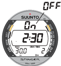
Bild 4.13. Dyktidslarm. Mindre än fem minuters dyktid visas i mitten av displayen.
