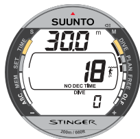
Bild 3.9. Planering. Den maximalt tillåtna tiden för direktuppstigning för 30 meter är 18 minuter i läge P0/A0.
