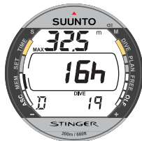
Bild 5.9. Minne för apparatdykningshistorik. Totalt antal dyk, antal dyktimmar och maxdjup.
