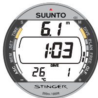
Bild 3.29. Fridykning. Aktuellt djup är 6,1 meter, dyktid 1,03 minuter och dyknummer 1.
