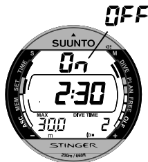
Fig. 4.13. Duiktijdalarm. In het midden van het display ziet u een duiktijd van niet meer dan 5 min.
