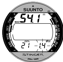
Fig. 4.9. Het instellen van het zuurstofpercentage en de maximale partiële zuurstofdruk.
