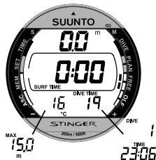
Fig. 3.34. Het oppervlakte-display na een duik in de Gauge modus. Oppervlakte-interval in het middelste venster.
