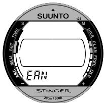
Fig. 4.7. EAN/Air instellingen wijzigen.
