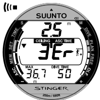
Fig. 3.20. Decompressieduik, boven het decompressieplafond. Let op het naar beneden wijzende pijltje, de Er -waarschuwing en het alarmsignaal. U dient onmiddellijk af te dalen tot beneden het decompressieplafond.
