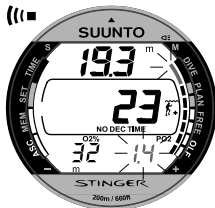
Fig. 3.23. Partiële zuurstofdruk en OLF displays. Wanneer de grens van 80% bereikt wordt op de Oxygen Limit Fraction staafgrafiek zal het laatste segment knipperen en hoort u een alarmsignaal. Als de OLF ooit 100% bereikt, knipperen alle segmenten. Als de OTU waarde groter is dan de CNS% waarde, zal het onderste segment knipperen.
