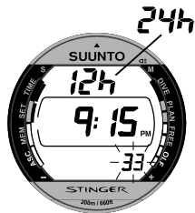
Fig. 4.3. Hier kunt u de tijd instellen. De secondenwijzer knippert. Pagina I.
