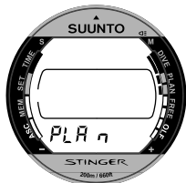
Fig. 3.8. Duikplanning. De duikplanner wordt aangeduid met de functie-indicator en de tekst PLAN.
