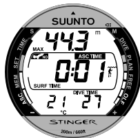
Fig. 3.26. Oppervlaktemodus na een overgeslagen decompressiestop. Het ASC TIME symbool blijft zichtbaar als teken dat u langer dan 3 minuten boven uw decompressieplafond bent geweest. Op het tweede display ziet u dat u minimaal 48 uur niet mag duiken.
