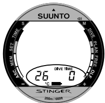
Fig. 3.6. Lage batterijspanning. Het batterijsymbool wil zeggen dat de batterij bijna leeg is en vervangen moet worden.
