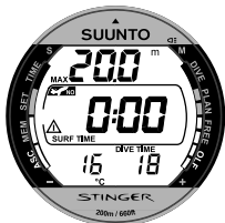
Fig. 3.24. Oppervlakedisplay. U bent boven gekomen na een duik van 18 minuten op 20.0 m. De huidige diepte is 0.0 m en uw oppervlakte-interval is 0 min. Een vliegtuigsymbool geeft aan dat er een vliegverbod geldt en het attentiesymbool houdt in dat u uw oppervlakte-interval dient te verlengen voordat u weer duikt.
