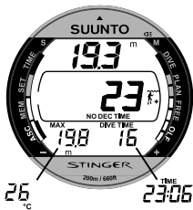
Fig. 3.11. Het duikdisplay. De huidige diepte is 19.3 meter en de resterende geen-decompressietijd of nultijd is 23 min. in stand A0/P1. De maximum diepte van deze duik was 19.8 meter en de duiktijd is nu 16 minuten. Op de alternatieve displays ziet u de watertemperatuur en de huidige tijd.
