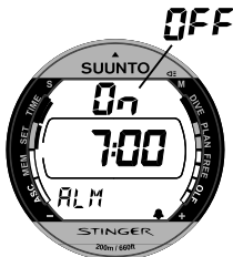
Fig. 4.6. Functie voor het instellen van de wekker, na activering.
