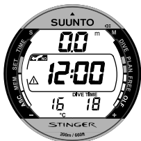
Fig. 3.25. Oppervlakedisplay. Na het wisselen van het display ziet u de resterende tijd van het vliegverbod.
