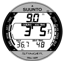
Fig. 3.18. Decompressieduik, boven de decompressie-oergrens. Het naar boven wijzende pijltje is verdwenen en het ASC TIME symbool knippert niet langer.
