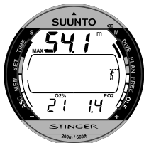
Fig. 3.21. Nitrox display. De maximum diepte voor het ingestelde O 2 percentage (21%) en de huidige maximale PO 2 (1.4 bar) is 54.1 m [177 ft].
