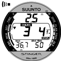
Fig. 3.14. Overgeslagen Verplichte Veiligheidsstop. De naar beneden wijzende pijl en het alarmsignaal geven aan dat u af moet dalen tot beneden het plafond.
