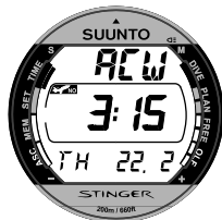
Fig. 2.3. Als het watercontact is actief is ziet u ACW op het display.
