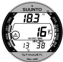
Fig. 3.7. Aandachtspunten. U kunt een annotatie of aandachtspunt in het duikprofiel plaatsen door de S knop in te drukken. Het Attentiesymbool licht kort op.
