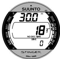
Fig. 3.9. Duikplanning. De geen-decompressielimiet (nultijd) op 30 meter is 18 minuten in stand A0/P0.
