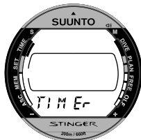
Fig. 2.6. De Stopwatch functie wordt aangeduid met de tekst TIMER en een functie-indicator.
