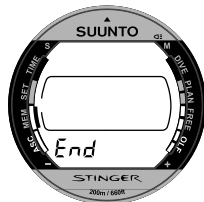
Fig. 5.7. Logboek, einde van het geheugen. De END tekst wordt getoond na de laatste en voor de eerste duik in het geheugen.
