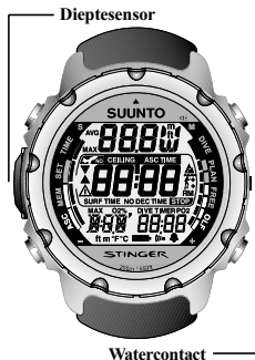
Fig. 2.2. Het watercontact en de dieptesensor.
