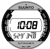
Fig. 2.7. De stopwatch toont u de uren, minuten, seconden en tienden van seconden.
