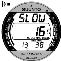
Fig. 3.15 Stijgsnelheidsmeter. Wanneer een knipperende SLOW waarschuwing en vier segmenten zichtbaar zijn hoort u tevens een alarmsignaal als teken dat uw opstijging sneller is dan 10 m/min. Rem uw opstijging onmiddellijk af! Het STOP symbool wil zeggen dat u een Verplichte Veiligheidsstop moet maken wanneer u een diepte van 6 meter bereikt.
