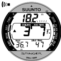
Fig. 3.17. Decompressieduik, beneden de ondergrens. Een naar boven wijzende pijl, een knipperend ASC TIME symbool en een alarmsignaal wijzen u erop dat u op moet stijgen. De minimaal benodigde tijd is 7 minuten.
