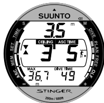
Fig. 3.19. Decompressieduik, binnen de optimale decompressiezone. Twee pijltjes wijzen naar elkaar en vormen een zandloperkje. U zit nu op 3,5 meter diepte binnen het ideale gebied om uw decompressiestop te maken; deze duurt nog 5 minuten.
