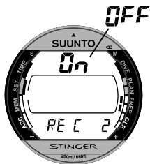
Fig. 4.11. Het activeren en deactiveren van de Free diving modus en het kiezen van de opname-interval.
