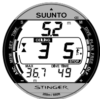
Fig. 3.13. Een Verplichte Veiligheidsstop. U dient een veiligheidsstop te maken in het gebied tussen het plafond en de ondergrens.
