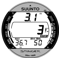
Fig. 3.12. Een Aanbevolen Veiligheidsstop van 3 minuten.
