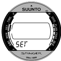
Fig. 4.1. De Set modus wordt aangeduid met de tekst “Set” en de functie-indicator aan de linker zijde van het display.
