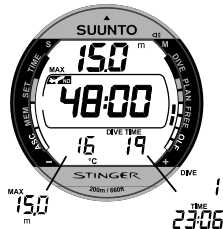
Fig. 3.35. Wisselend display na een duik in de Gauge modus. In het middelste venster staat nu de tijd van het vliegverbod.
