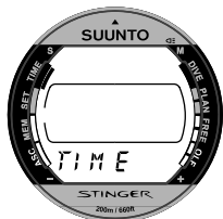
Fig. 2.4. De Tijdsmodus wordt aangeduid met de TIME tekst en de functie-indicator.
